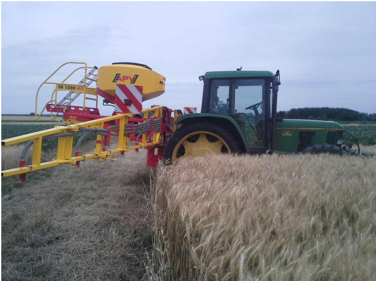
Abb.3: Vordruschsaat in Neckenmarkt Ende Juni 2015 in den stehenden Weizen – Aussaat mittels pneumatischer Verteilung
