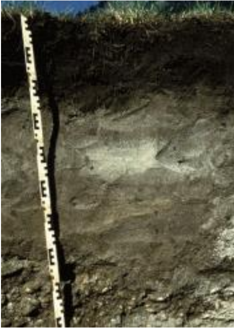
Abb.4: Profilbild eines leichten Bodens (10% Tongehalt)
