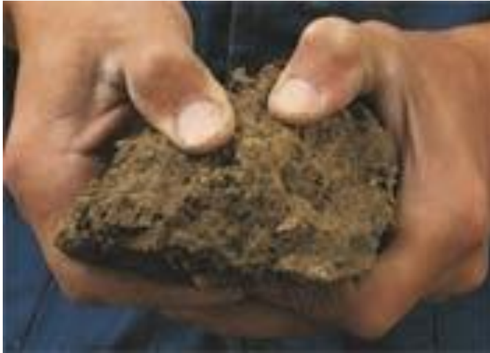
Abb.2: Kennbild für die Bodenfeuchtigkeitsklasse „trocken“: Brocken lassen sich in der Hand nicht zerdrücken
