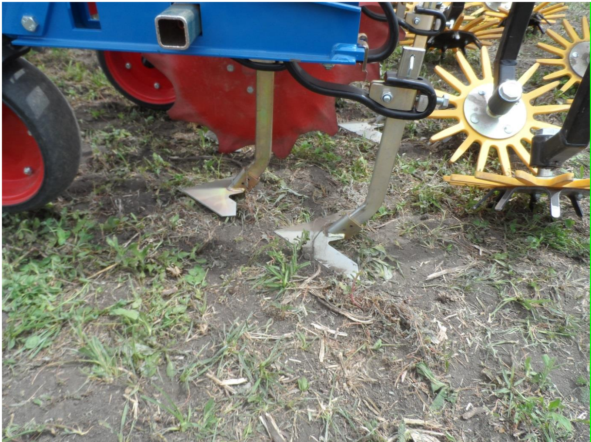
Abb.11: Vibrozinken mit stabilem Einzugswinkel der Schare
