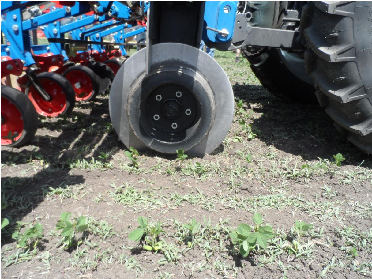
Abb.6: Spurführungsräder des Verschieberahmens
