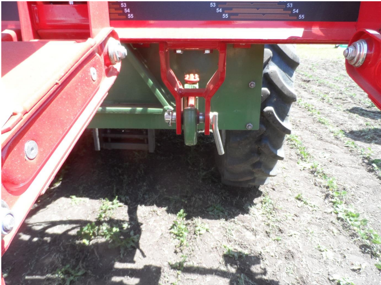
Abb.5: Spielfreie Verbindung zwischen Verschieberahmen und Hackgerät: Die Unterlenkerkugeln stehen auf beiden Seiten, z.B. innen an der Aufnahme, an
