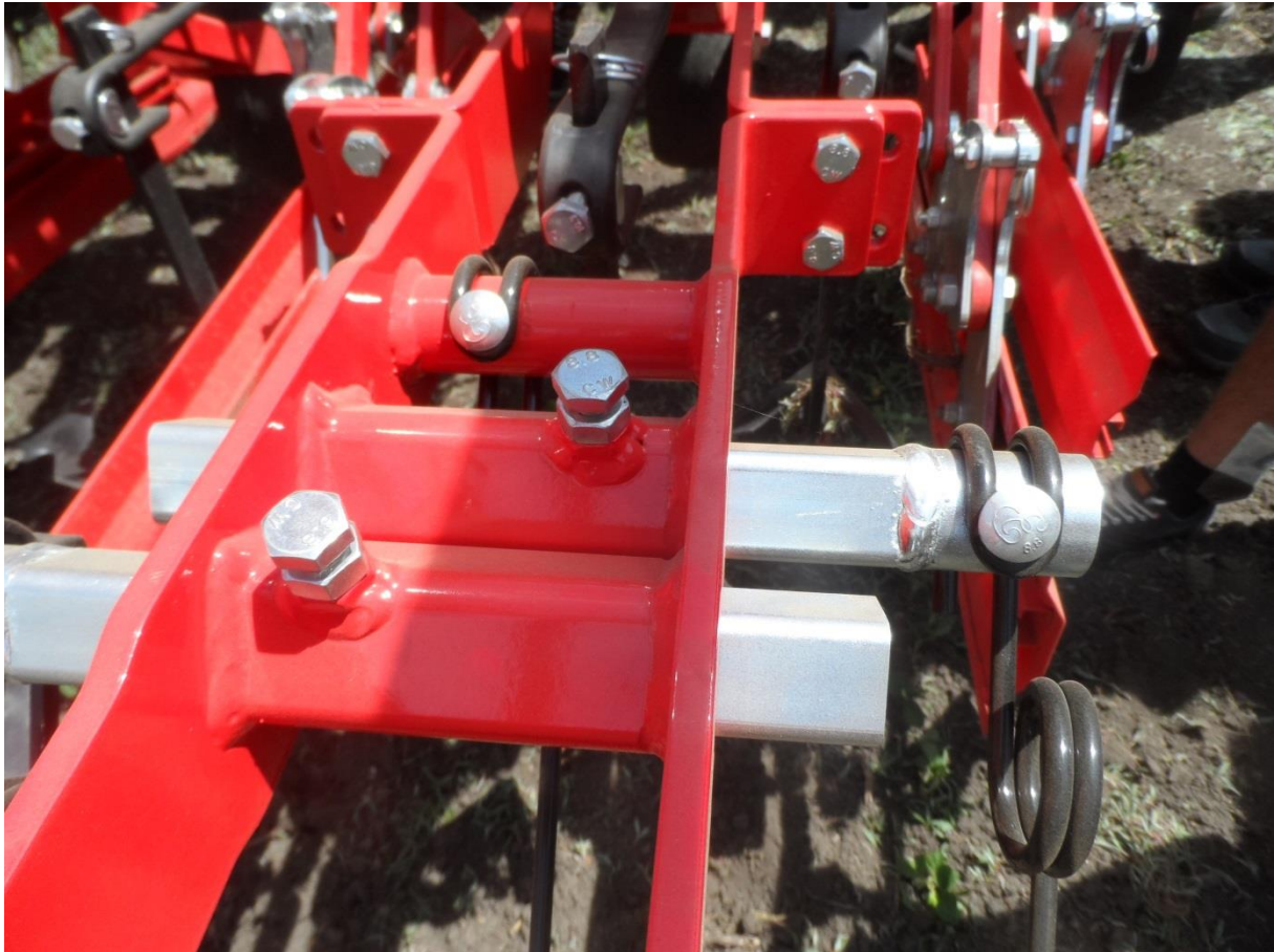
Abb.18: Einstellmöglichkeit der äußeren Zinken
