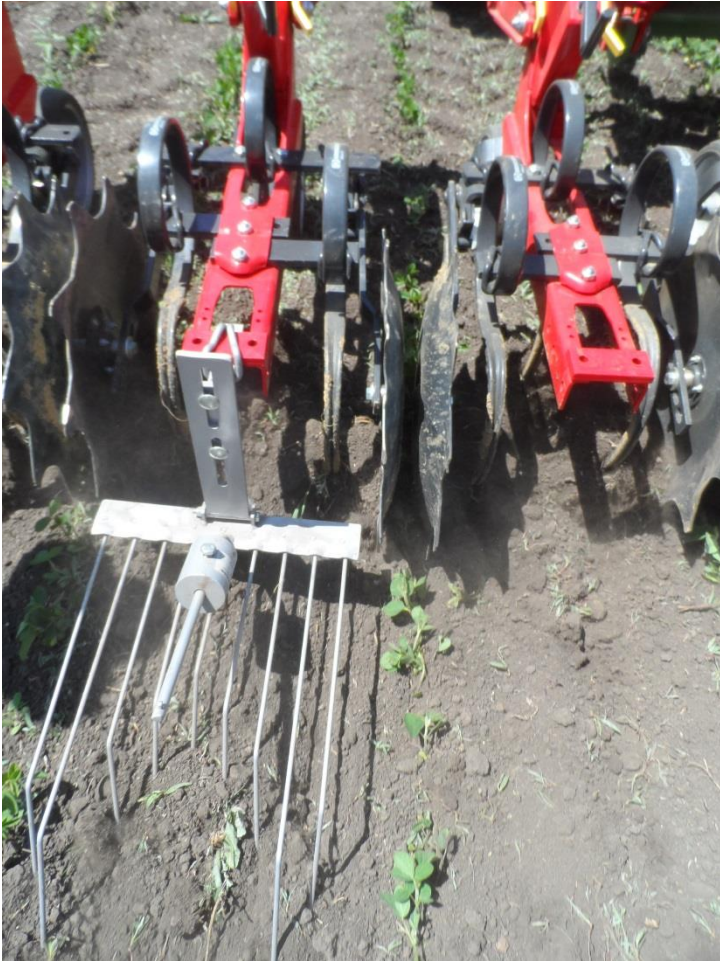
Abb.16: Der Striegel- Nachläufer enterdet Unkräuter, zerkleinert Brocken und ebnet ein
