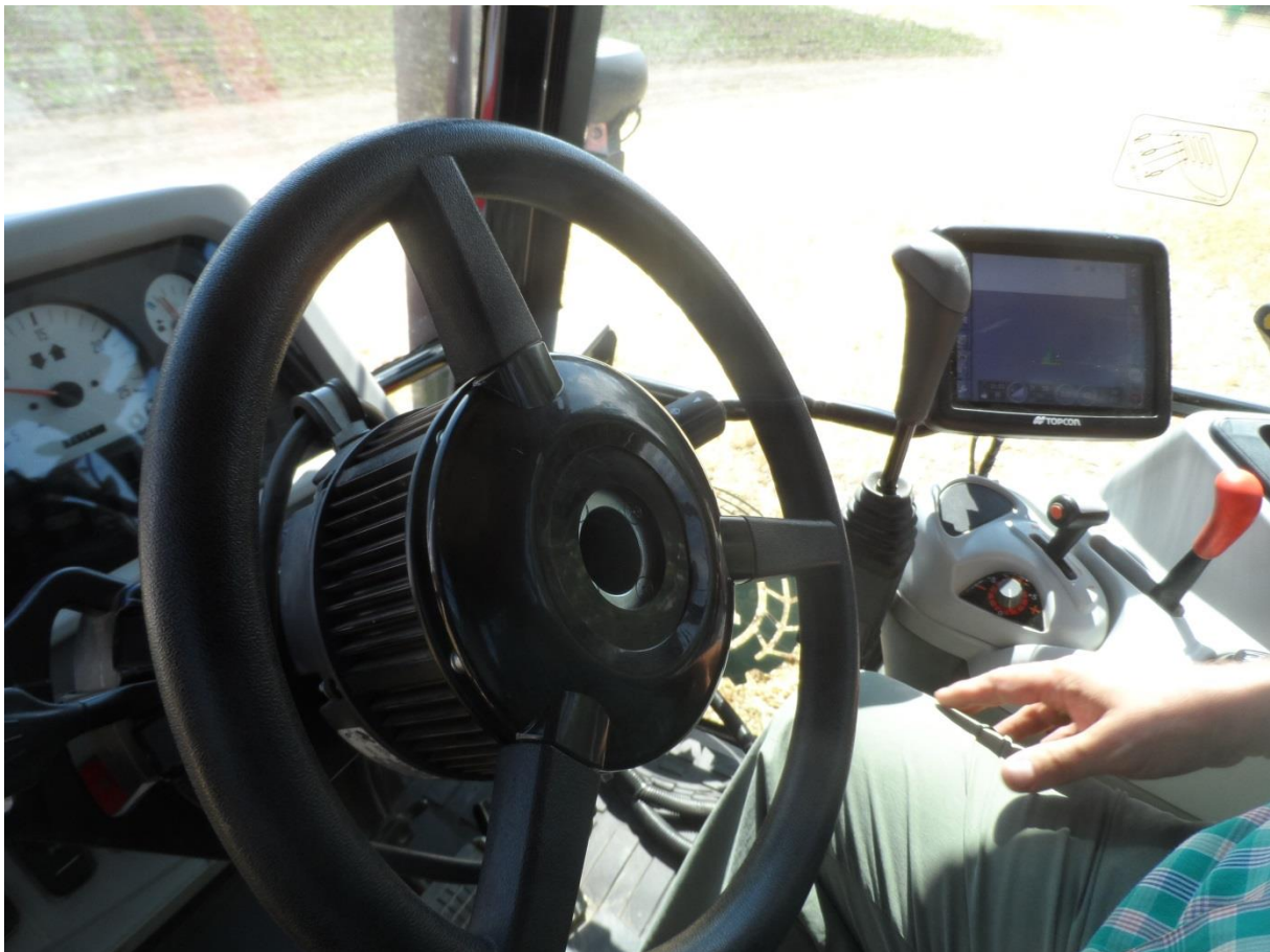
Abb.1: RTK System mit Lenkautomat zur exakten Anlage der Versuchspartzen
