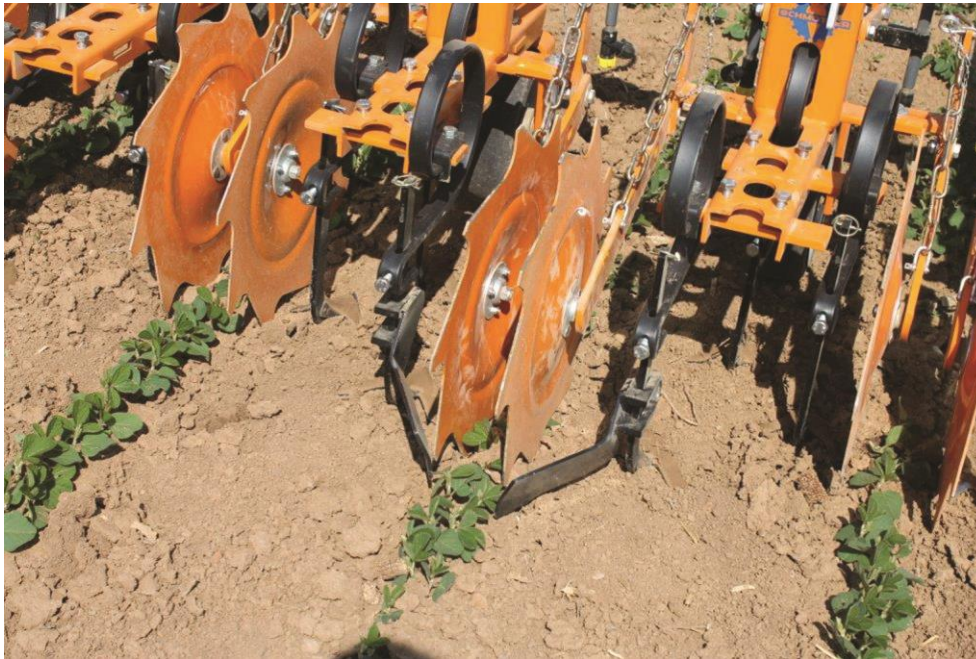
Abb.20: Flachhäufel beim flachen Anhäufeln von Sojabohne
