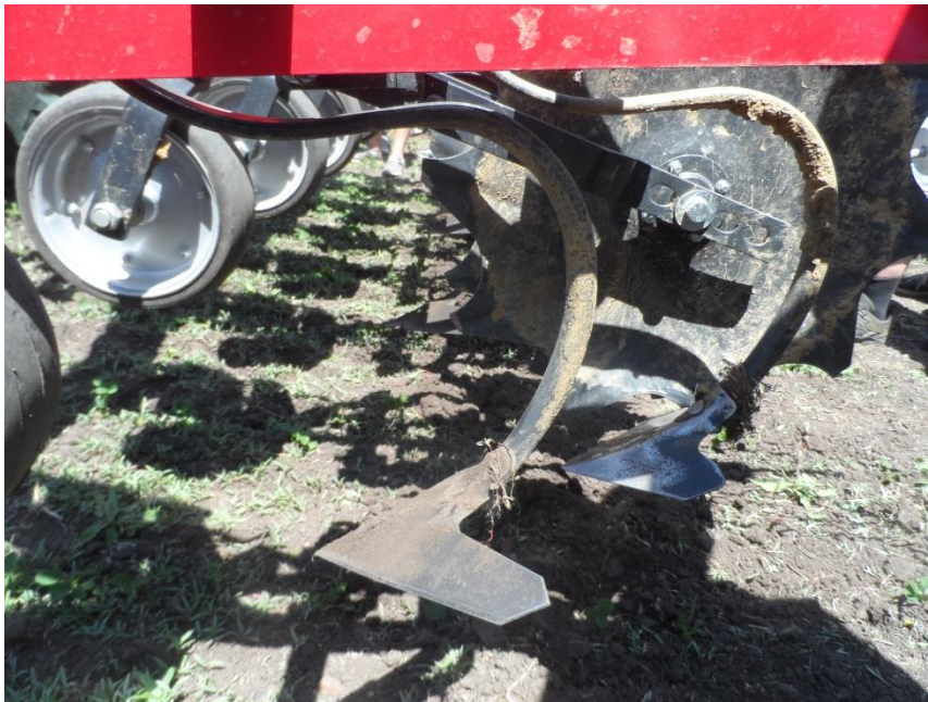
Abb.10: S-Zinken mit variablem Einzugswinkel der Schare
