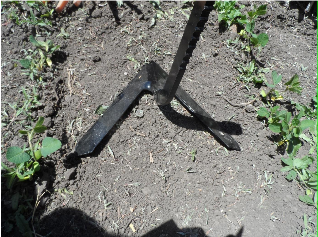
Abb.14: Ein Breitschar pro 50-cm Reihe (mit Rasterung an der Rückseite des Stiels zur einfachen Höhenverstellung)
