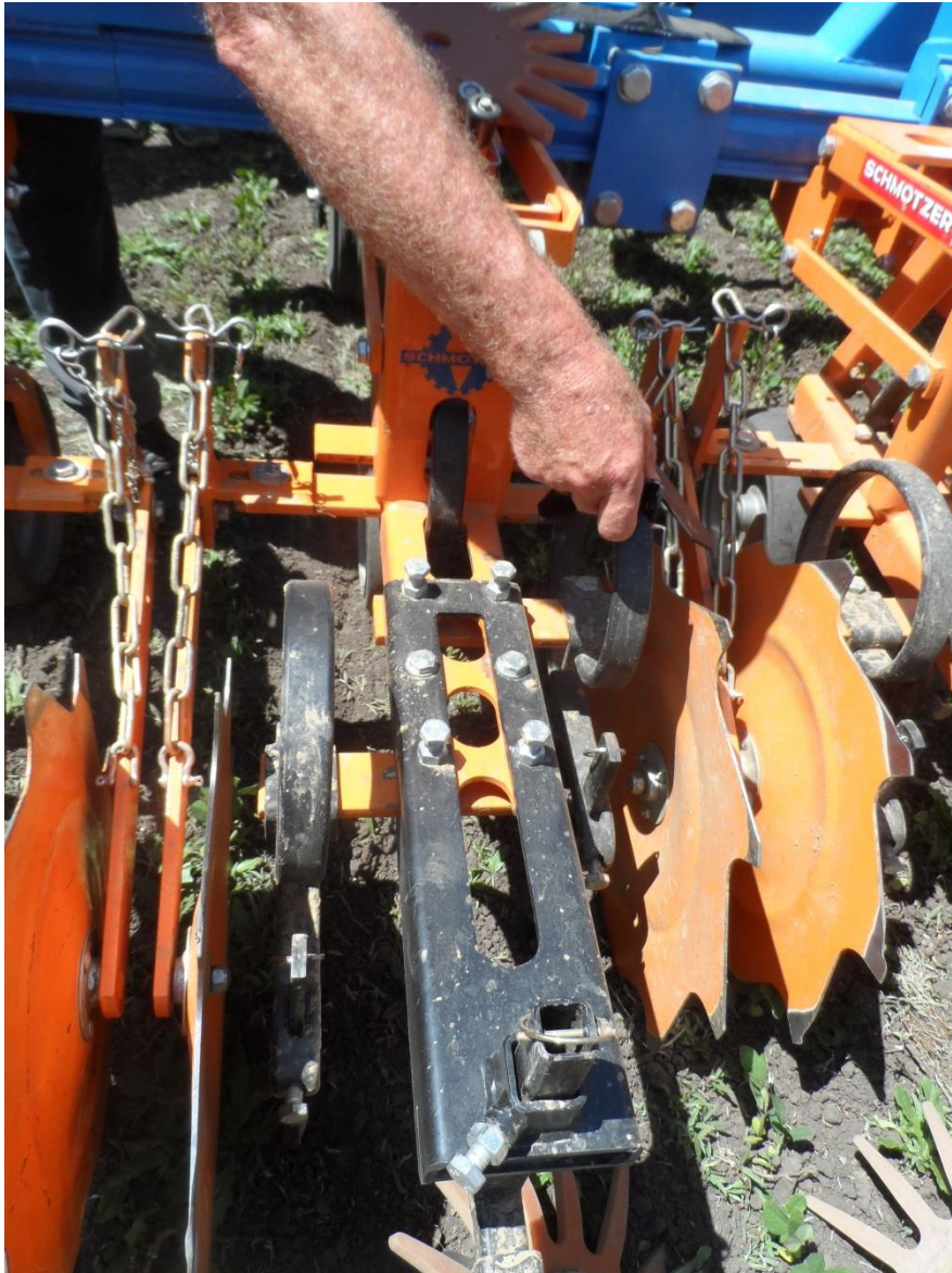
Abb.12: 3 Schare pro 50 cm-Reihe: ungleichmäßige Abnutzung der beiden hinteren Schare
