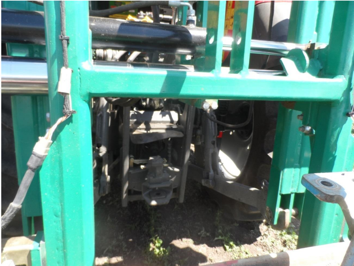
Abb.9: Einsatz eines Verschieberahmens z.B. beim Fräsen von Kartoffeldämmen: Zapfwellendurchgang beachten!
