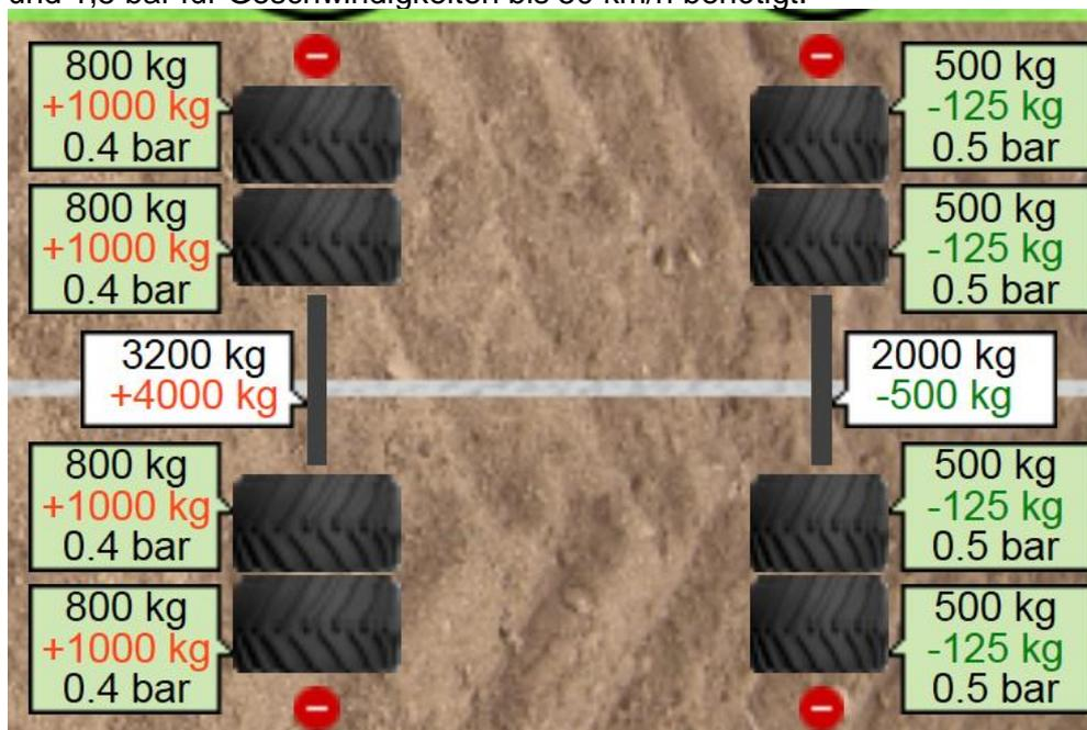
Abb.6: Lastverteilung mit Zwillingsbereifung des Traktors
