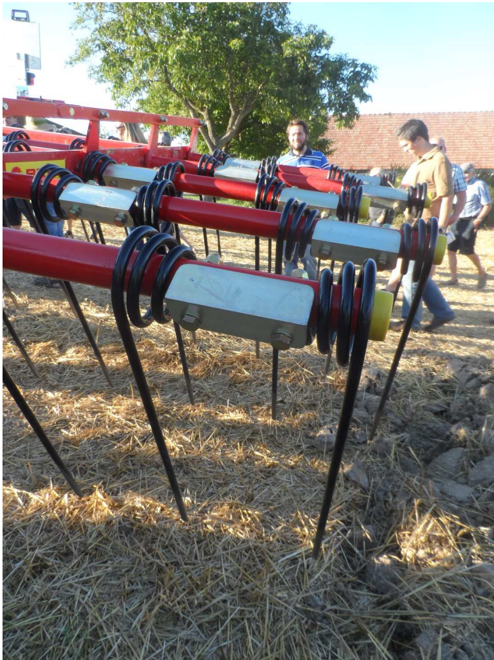
Abb.10: Doppelzinken mit großer seitlicher Beweglichkeit und variabler Befestigung am Rahmen
