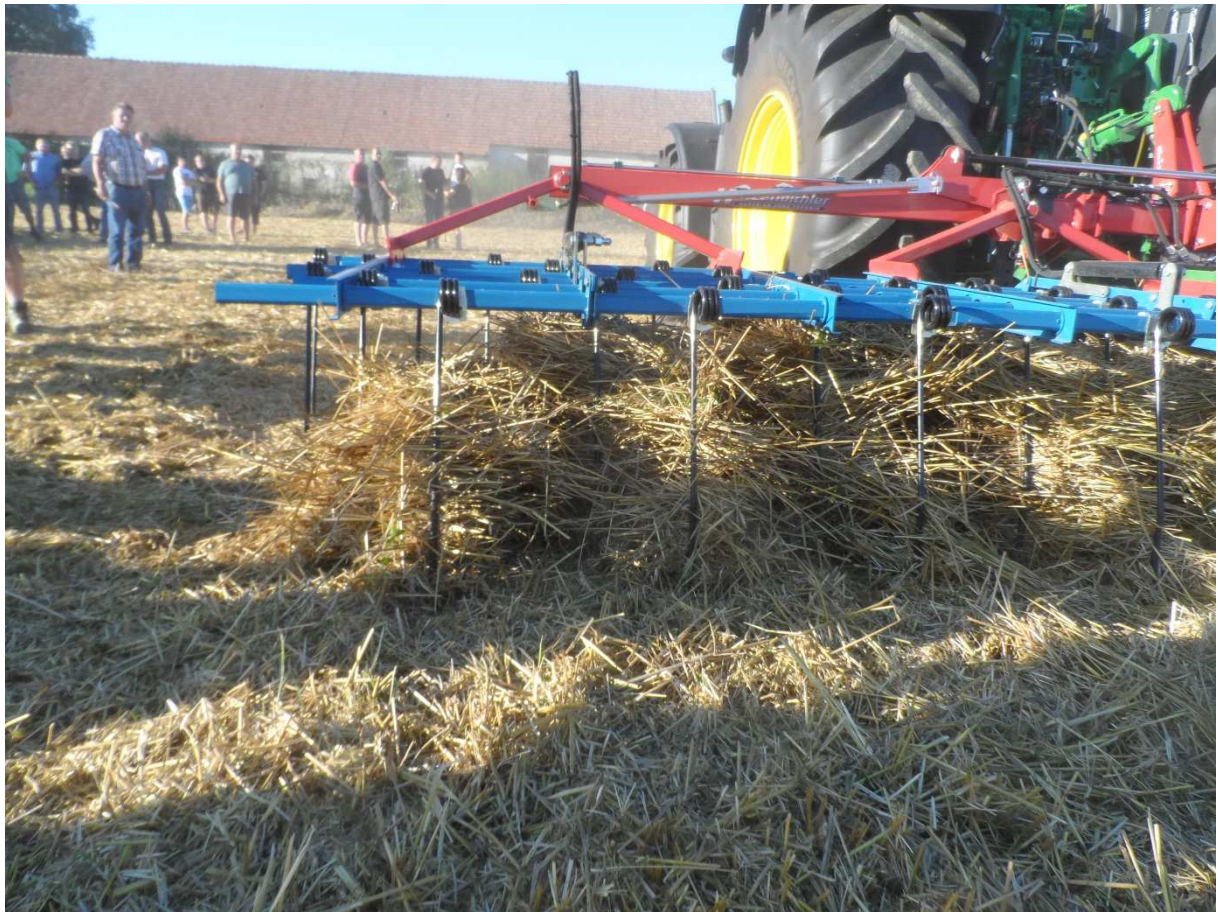
Abb.9: Stärkere Strohmatte im Striegel bei steilerer Zinkenstellung, engerem Reihenabstand und ev. größerer Strohmenge
