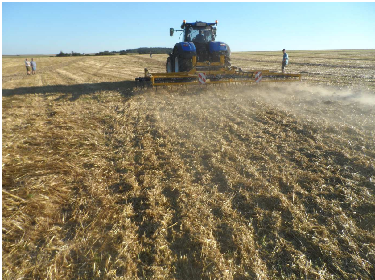
Abb.1: Arbeitsbild eines Strohstriegels
