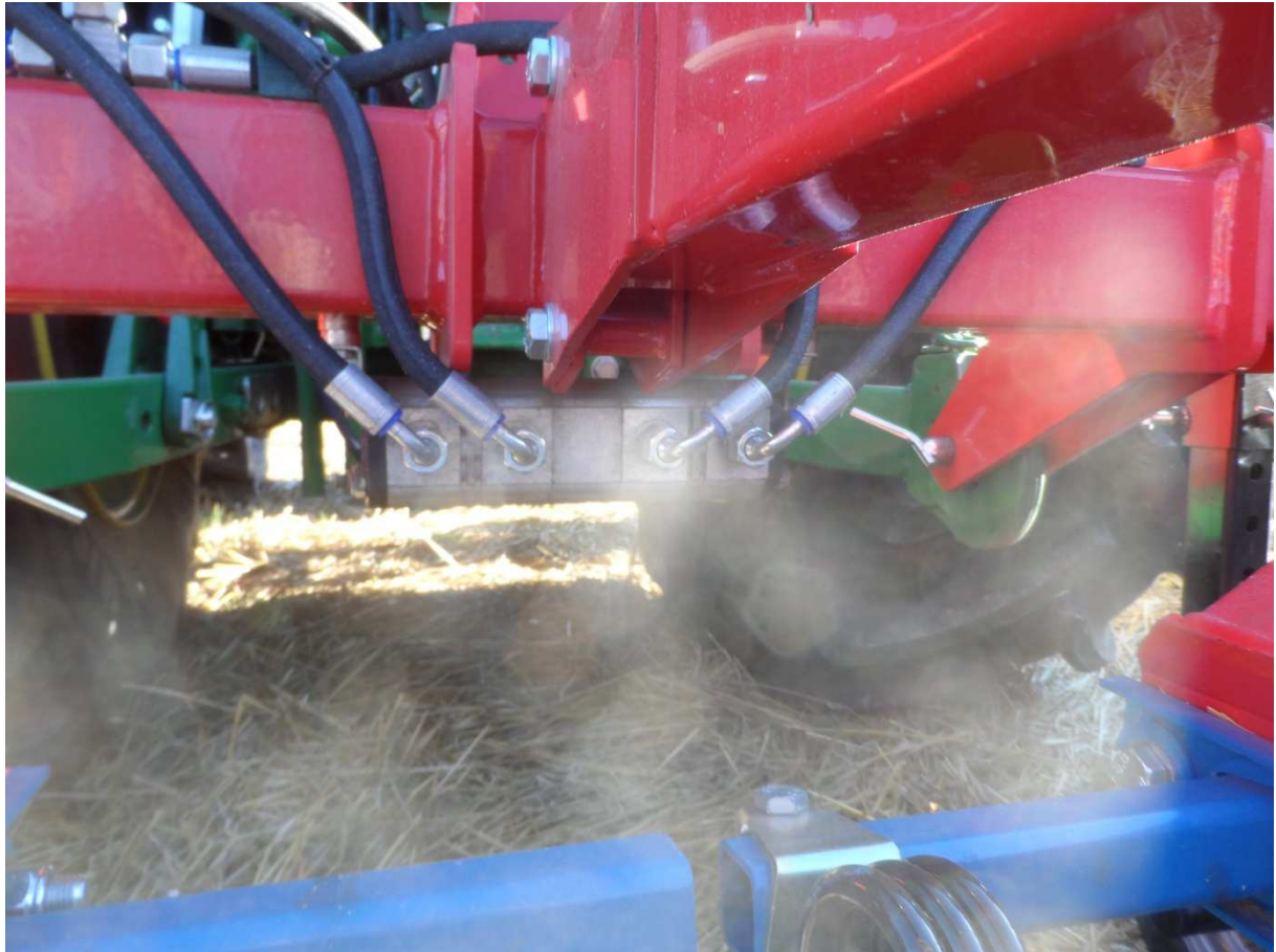
Abb.7: Durch einen Mengenteiler wird die gleiche Zinkeneinstellung bei allen Flügeln erreicht
