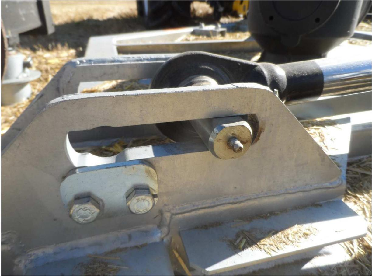
Abb.8: Bodenanpassung der Seitenflügel durch Langlochaufnahme
