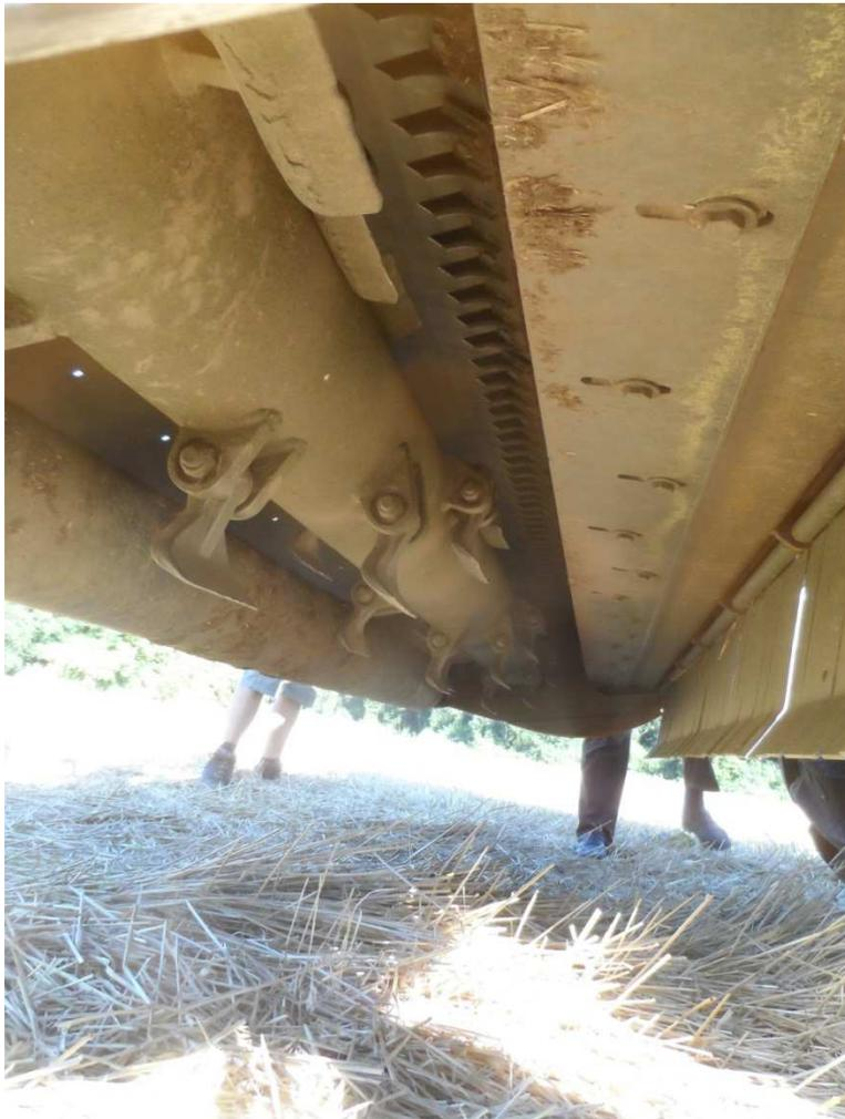
Abb.3: Ausstattung des Schlegelmulchers mit Hammerschlegeln und verstellbarer Schneidschiene
