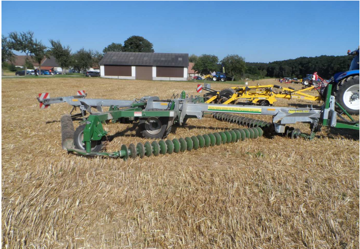
Abb.2: 6m-Ketten-Scheibenegge ohne Nachläufer
