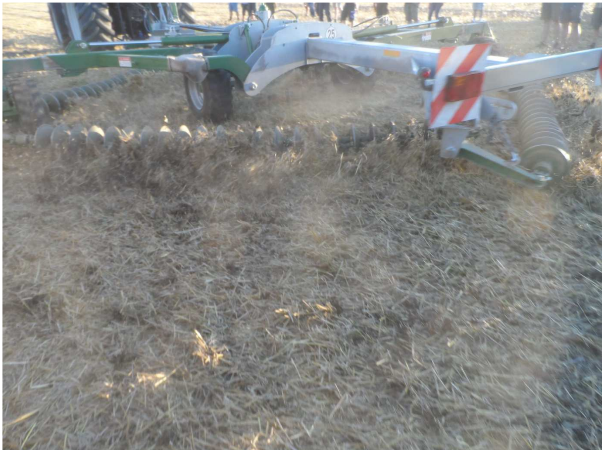
Abb.3: Möglichst hohe Geschwindigkeit beim Einsatz der Ketten-Scheibenegge
