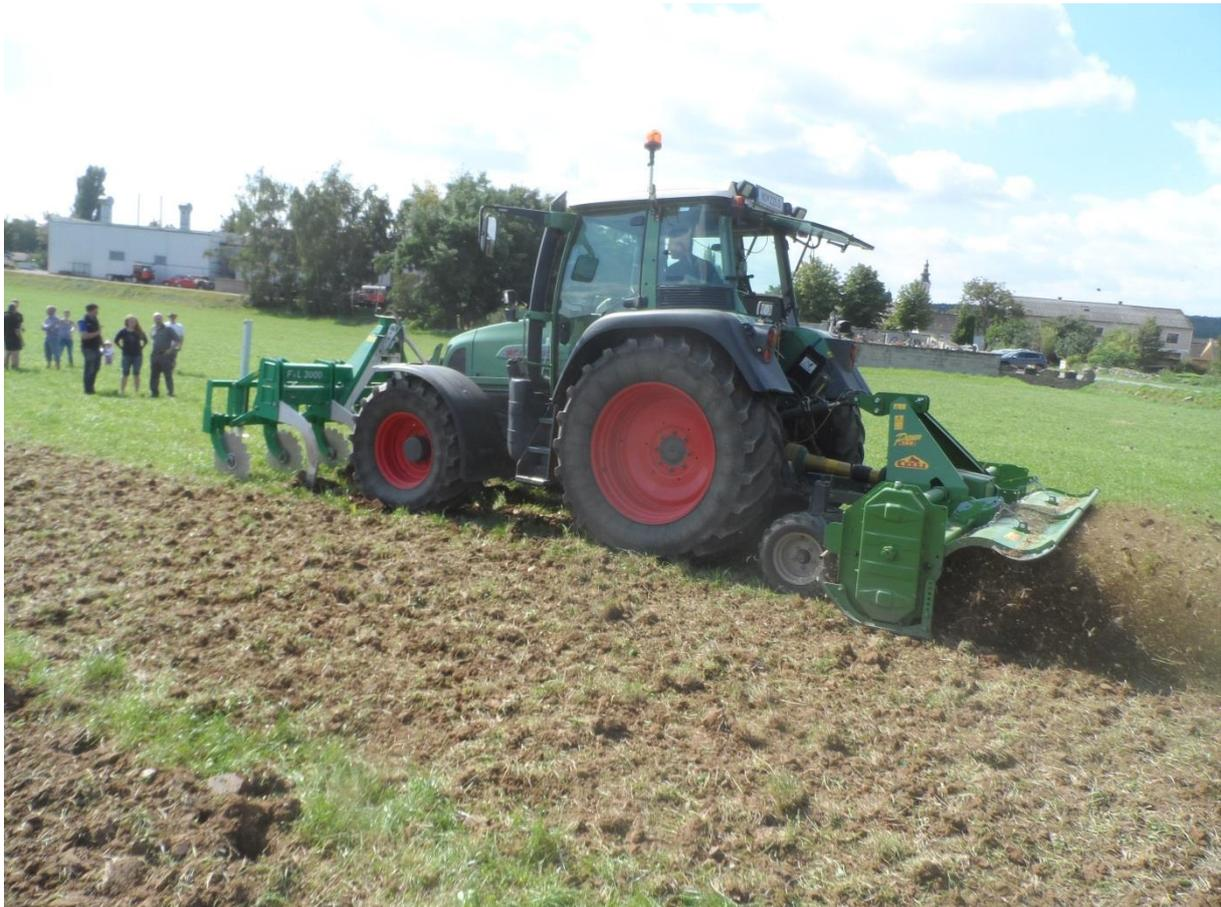
Abb.9: Front-Tiefengrubber und Fräse im Heckanbau
