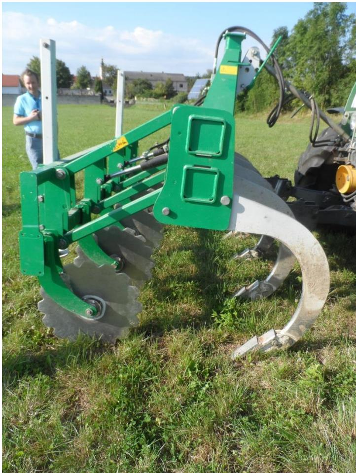
Abb.1: Front-Tiefenlockerer mit Schneidscheiben und Zinken
