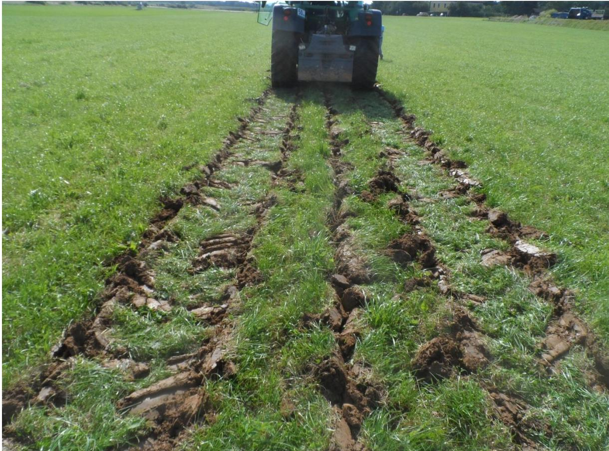
Abb.7: Front-Tiefenlockerer auf Klee gras: Traktor fährt auf bewachsenem Boden (60 cm Zinken-Strichabstand, 7cm Scharbreite, 180 cm Traktor-Spurweite)
