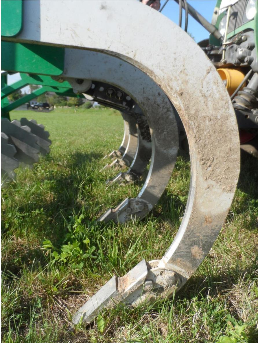
Abb.5: Weit nach hinten geschwungener Zinken, Bodeneingriff nur im Bereich des nach hinten geschwungenen Grindels
