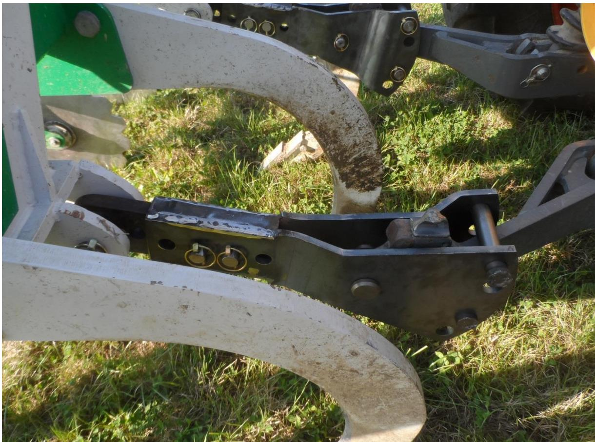
Abb.2: Anhängung der Unterlenker vor den Zinkenspitzen, Unterlenkerverlängerung
