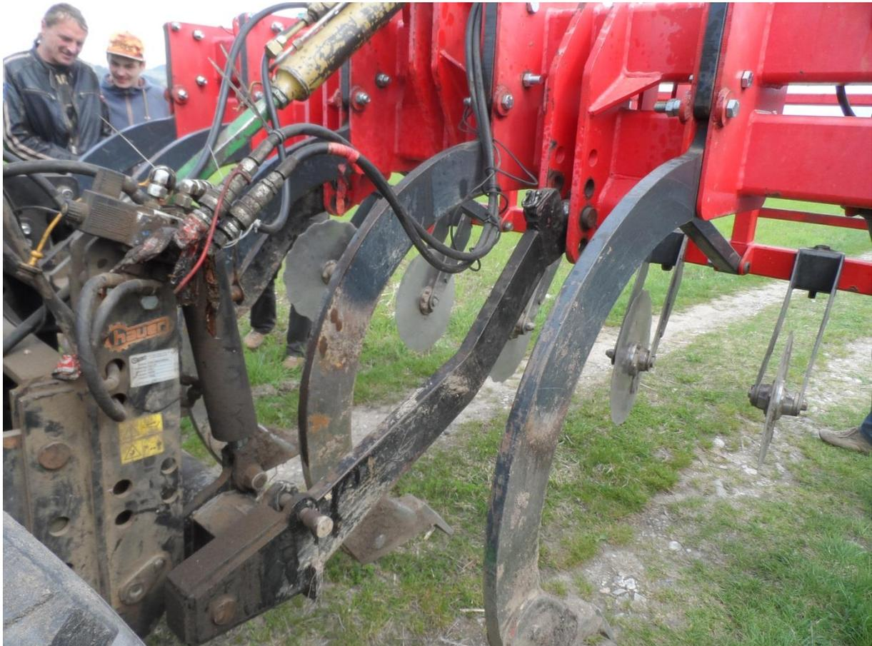
Abb.3: Verlängerte, gerade Unterlenker der Fronthydraulik
