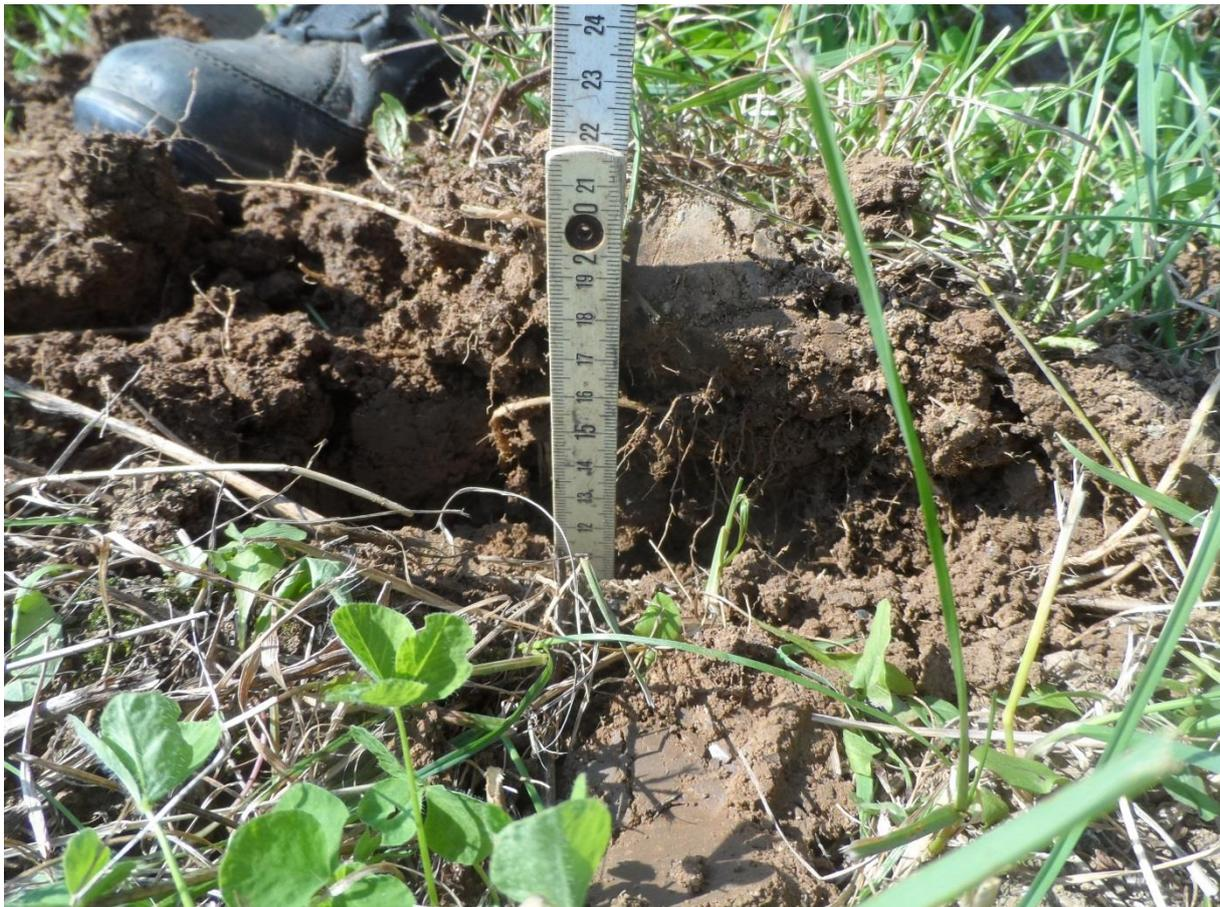
Abb.8: Arbeitstiefe auf 12cm begrenzt aufgrund von feuchtem, festem Boden
