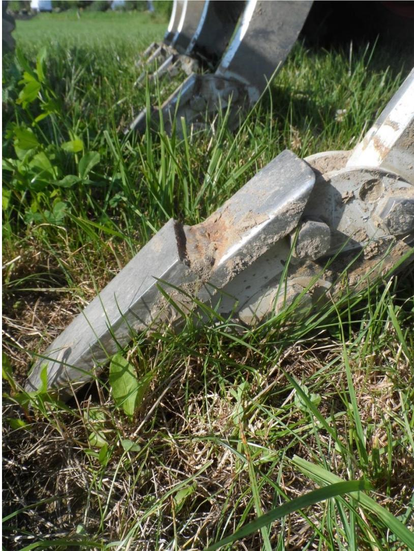
Abb.6: 7cm breite Scharspitzen, Anschweißen von gleich breiten Hardox-Platten mit gleichem Anstellwinkel und Untergriff
