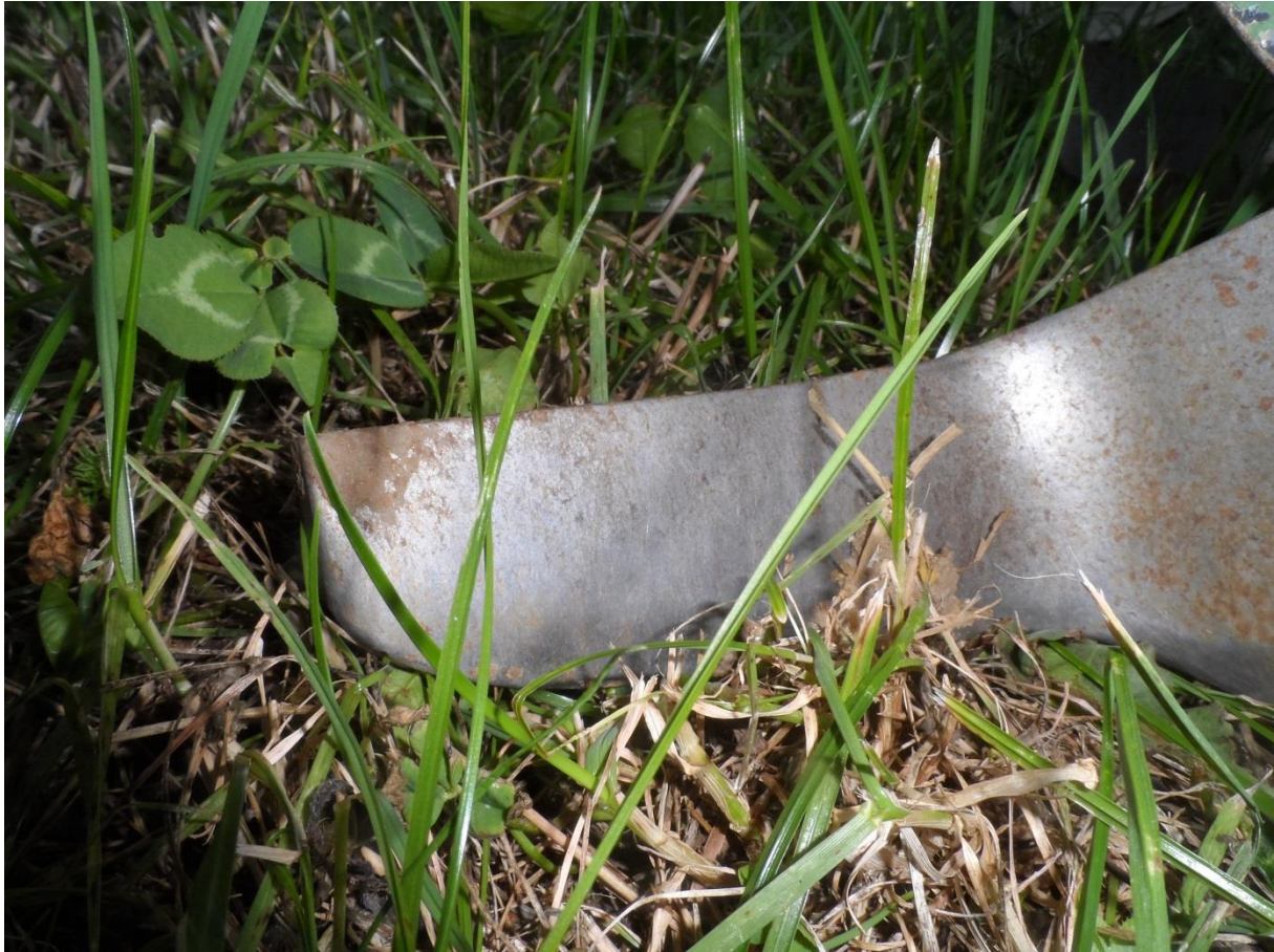
Abb.3: Winkelmesser mit großem Schneidwinkel
