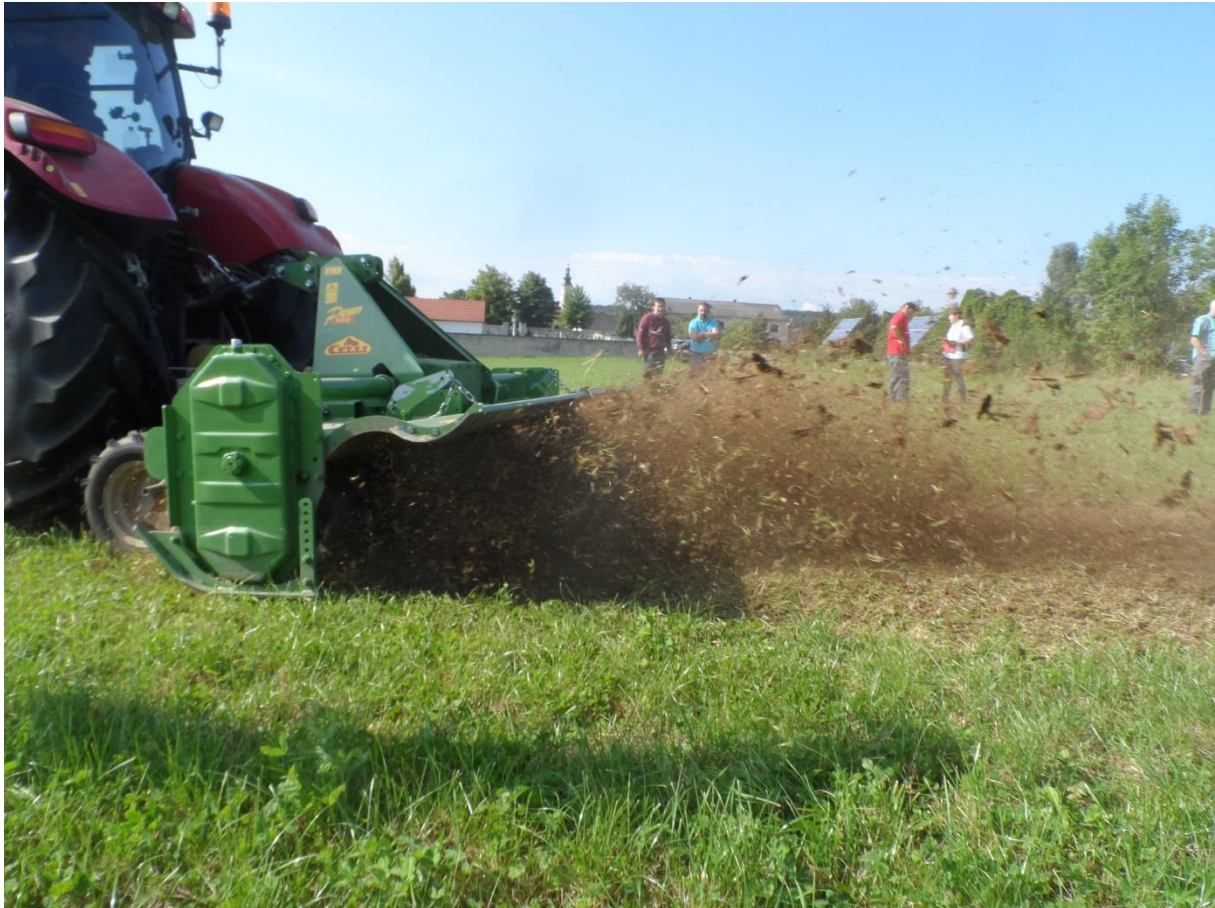
Abb.5: Offene Heckklappe – lockere, flache Ablage von organischer Masse und Erde
