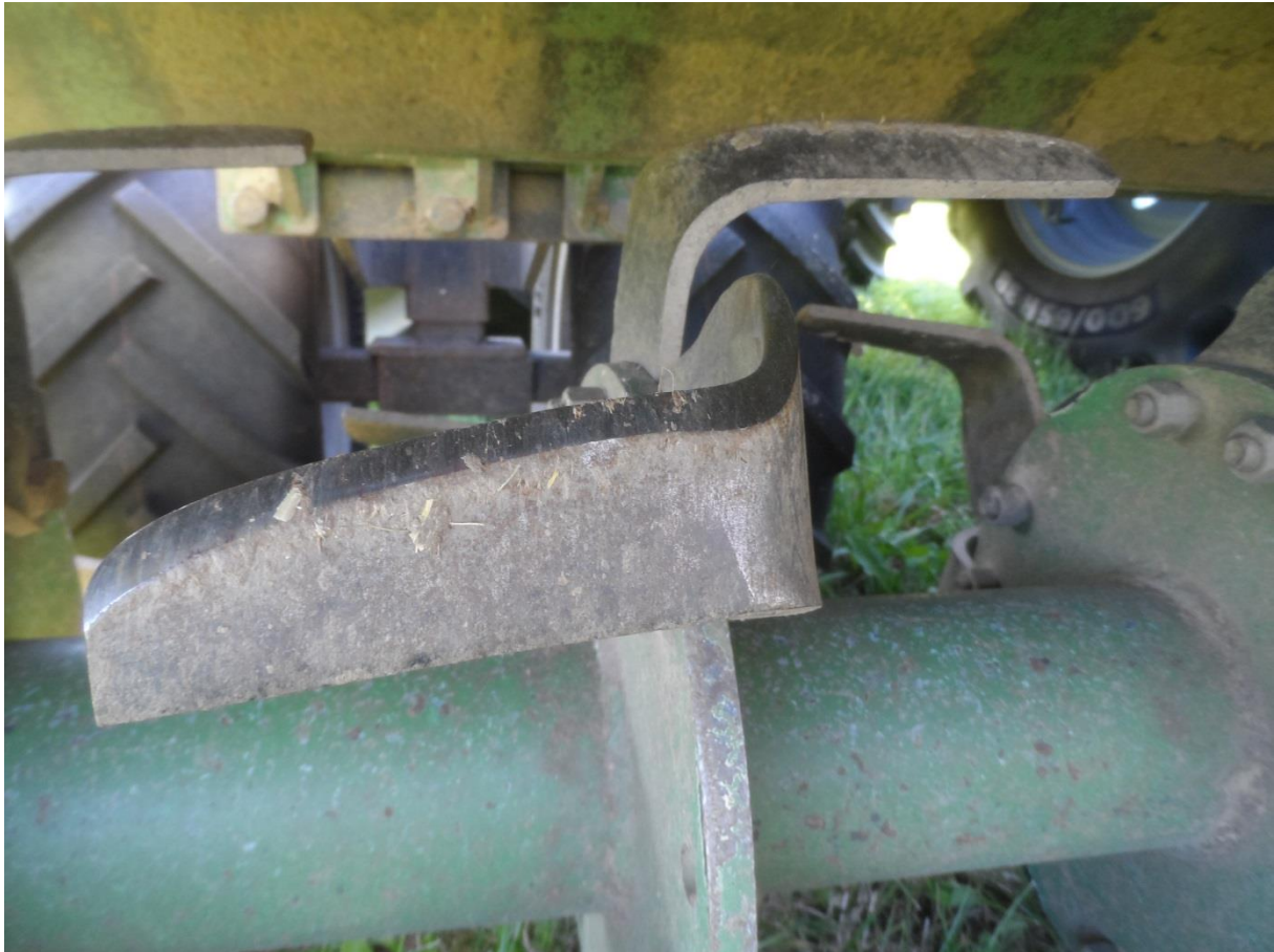
Abb.4: Winkelmesser mit nicht abgenutztem Messerrücken
