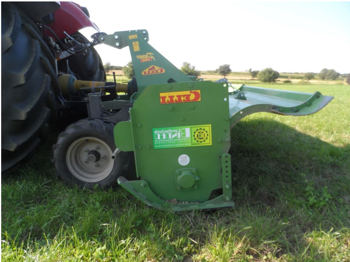
Abb.1: Bodenfräse mit Front-Zwillingsrädern, Winkelmessern, offener Heckklappe
