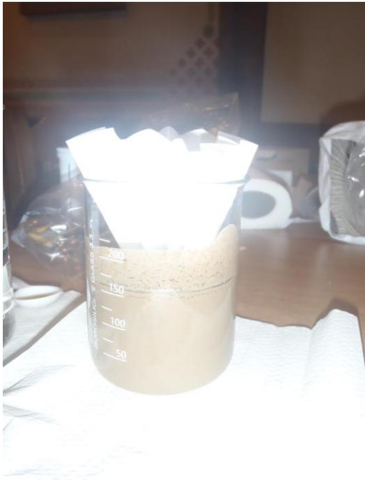
Durch einen Filter soll die Aufschlämmung in eine klare Flüssigkeit und in die Schwebteile getrennt werden. Es wird nur wenig klare Flüssigkeit für das Eintauchen eines Teststreifens benötigt. Eine einfache Möglichkeit ist, einen Filter in die Aufschlämmung zu stecken und zu warten, bis genügend klare Flüssigkeit in das Innere des Filters durchsickert. Sie können auch einen Kaffeefilter verwenden.
