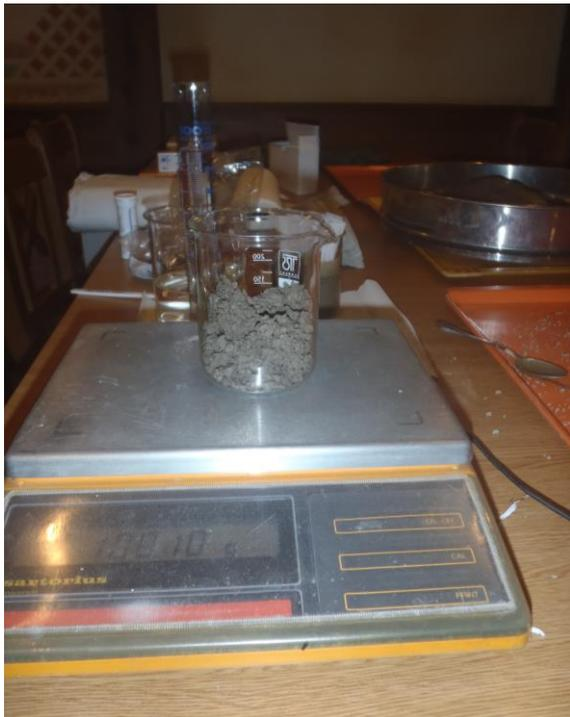
Wiegen Sie 100g Boden ab. Dies können Sie in jedem Gefäß mit jeder einfachen Waage (z.B. Küchenwaage durchführen).
