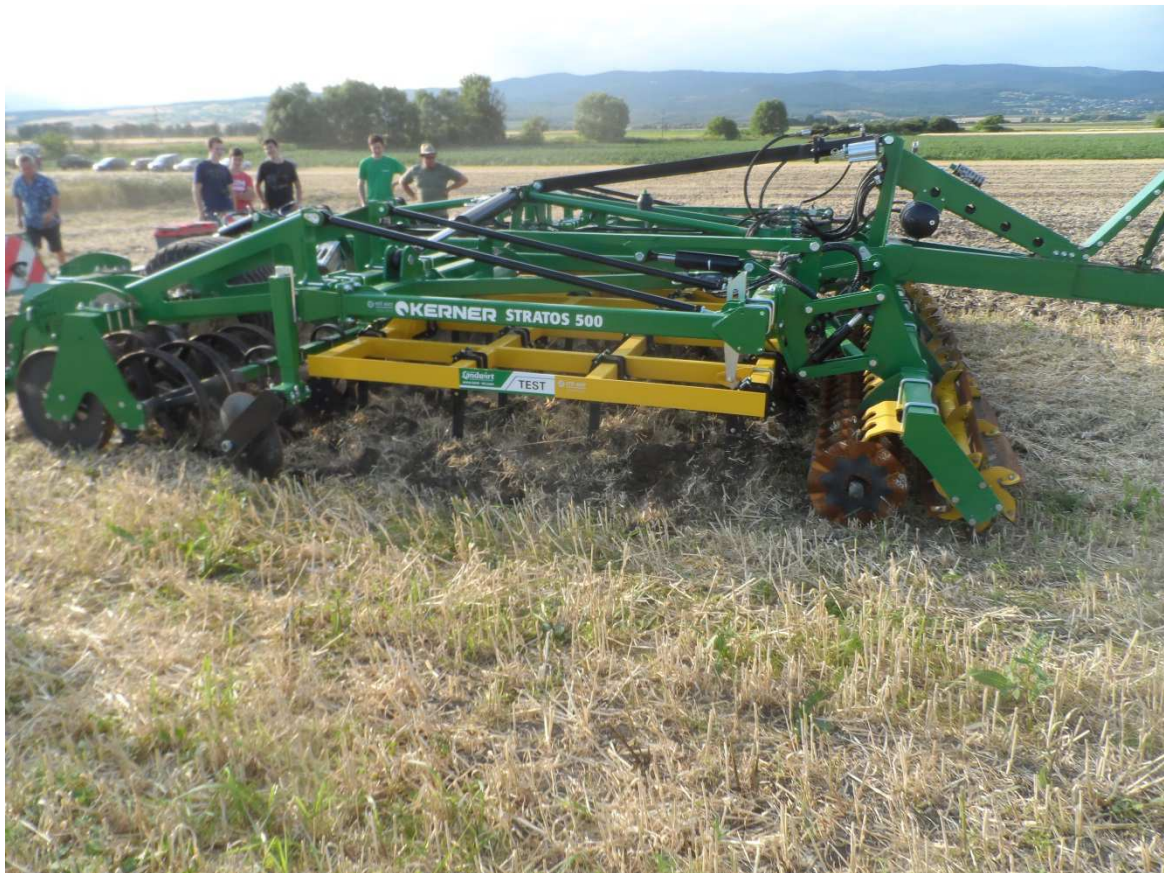
Abb.6: Fix montierte Messerwalze an einem gezogenen Grubber beim Stoppelsturz
