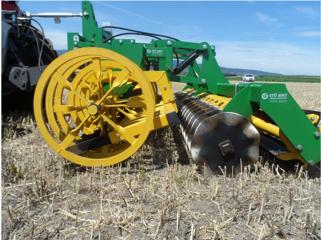
Abb.4: Mit Druck belastete Messerwalze, Packerwalze ausgehoben
