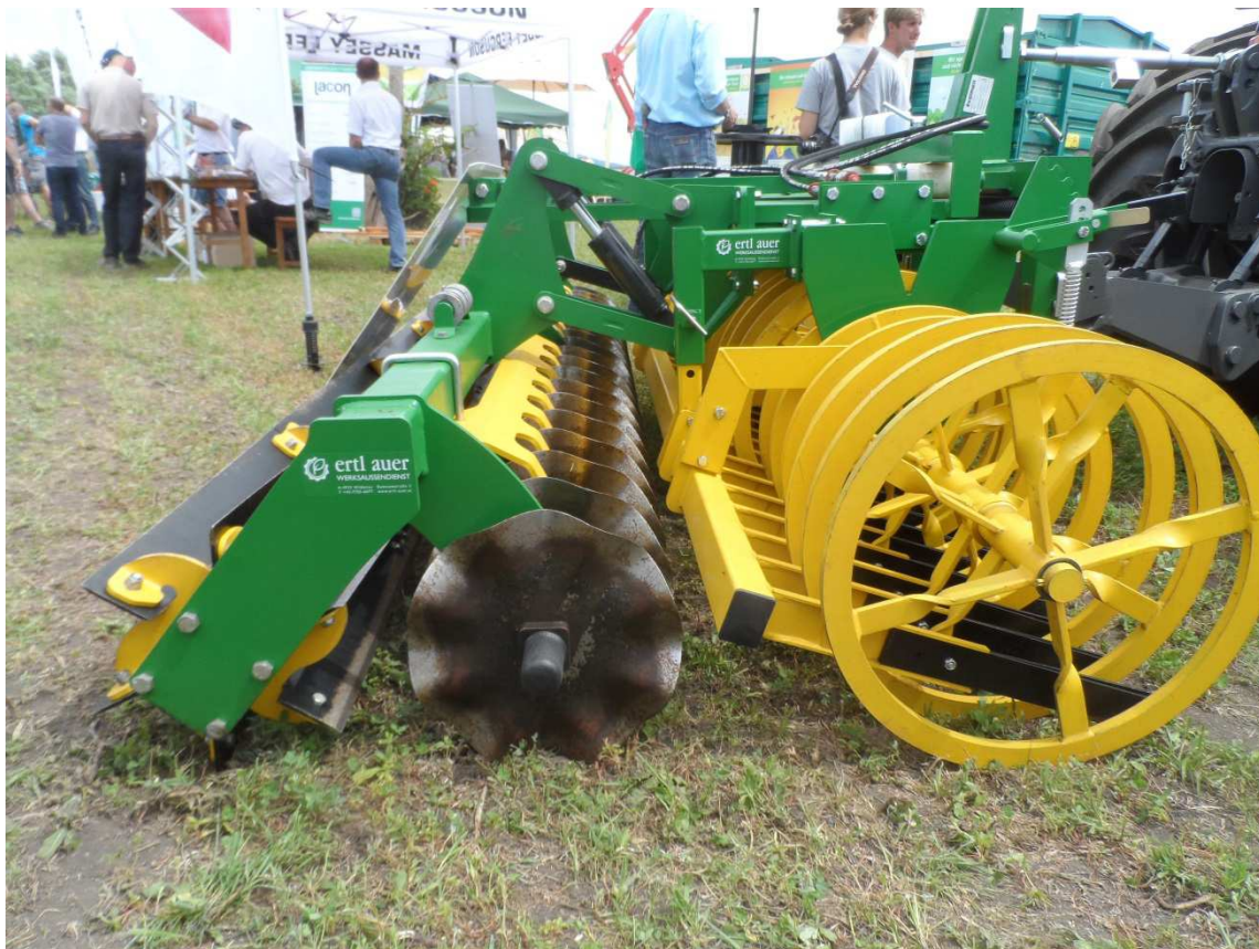
Abb.1: Messerwalze mit quer und längs schneidenden Messern sowie Packerwalze als Frontgerät
