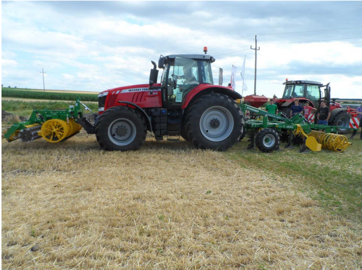
Abb.3: Kombination Front-Messerwalze mit Dreipunkt-Schwergrubber beim Stoppelsturz
