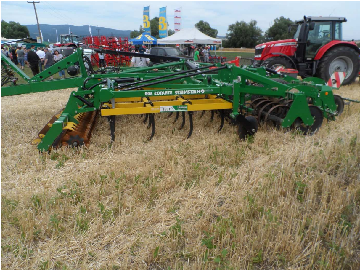
Abb.2: Messerwalze als Vorlaufgerät eines Grubbers
