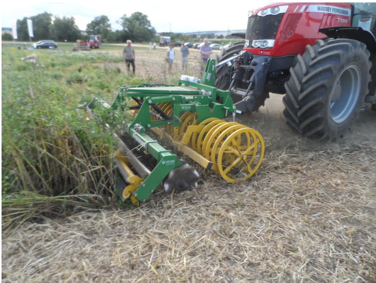
Abb.7: Front-Messerwalze beim Zerkleinern von Winter-Ackerbohnen (links) und Wintererbsen (Bildmitte)
