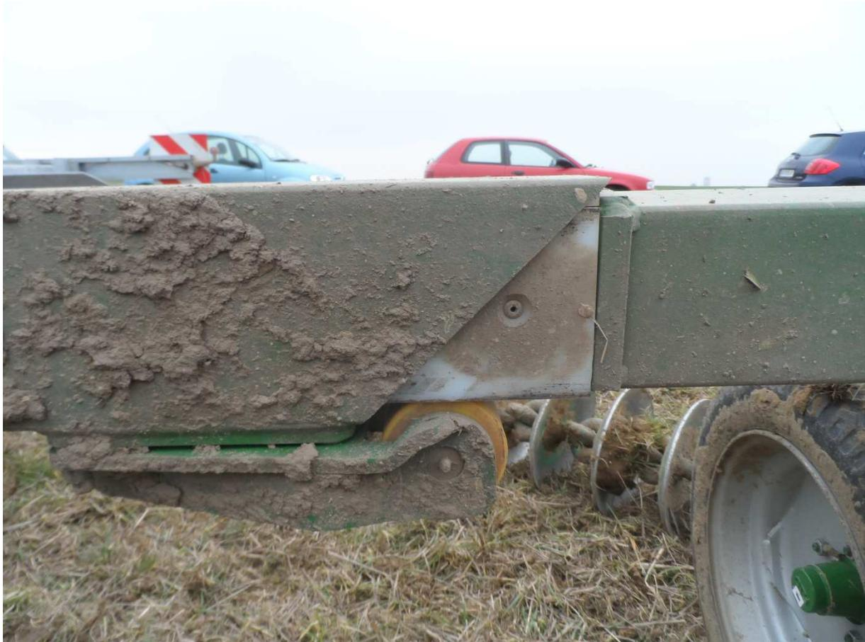
Abb.7: Hydraulischer Ausschub der Seitenflügel zur Vorspannung der Ketten
