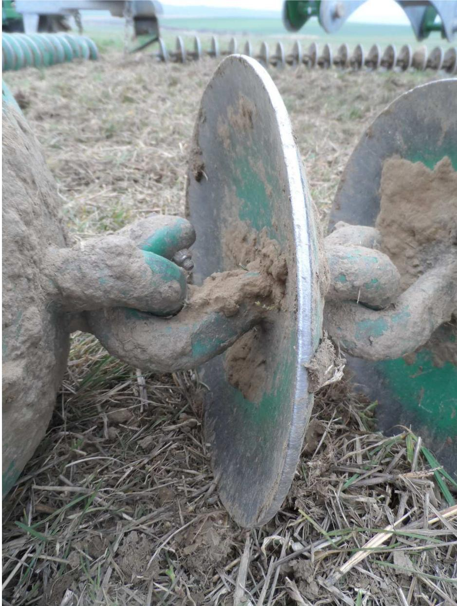
Abb.2: Stahlguss-Scheibe mit Kettengliedern
