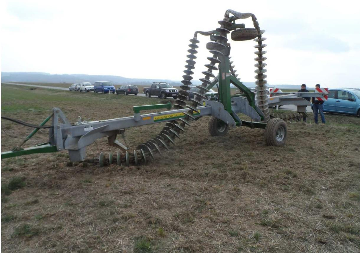
Abb.6: Ketten-Scheibenegge ohne Nachläufer in Transportstellung - zur Straßenfahrt muss die Dreipunkthydraulik noch angehoben werden
