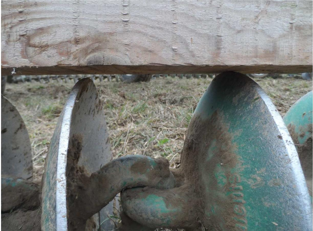
Abb.4: Boden Anpassung der Ketten-Scheibenegge an unebene Oberfläche – dargestellt durch Auflegen eines Pfostens auf die Scheibenoberkante
