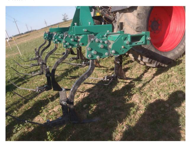
Abb.5: Häufelpflug mit schmalen, abgerundeten Spitzen und flachen, quergestellten Stäben, ohne Nachläufer (nicht im Bild: Tiefenführung durch Traktorhydraulik und Tasträder)
