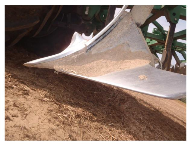
Abb.3: Schnellwechsel-Schar, bei dem ohne Schrauben die Flügel rasch demontiert werden können
