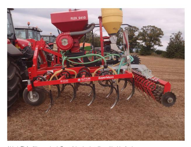
Abb.4: Tiefenführung durch Fronträder, hochstellbare Nachlaufwalze
