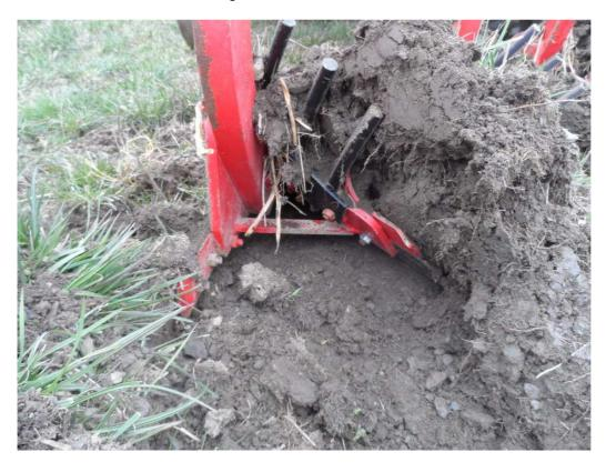
Abb.2: Seichte Arbeit mit Schälpflug mit dünnem, scharfen Schar und verringertem Streichblech
