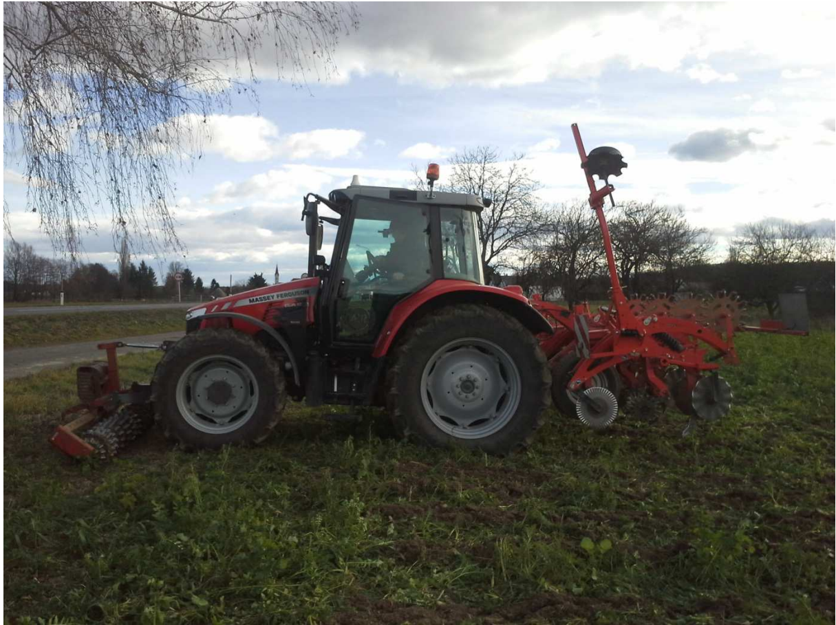
Abb.5: Frontanbau: Prismenwalze als aktives Frontgewicht Heckanbau: Strip Till in der gewalzten Begrünung – mit hochgeklappten Andruckrollen
