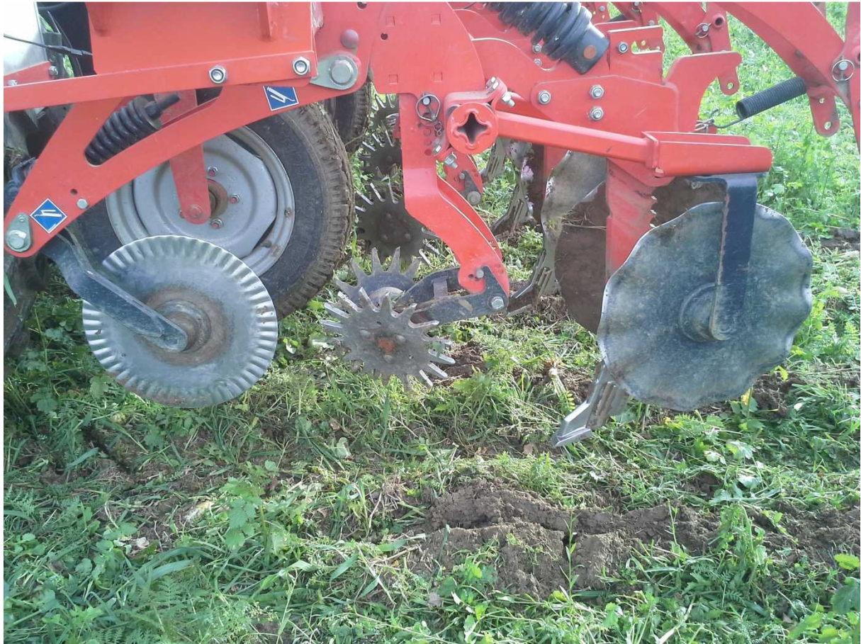
Abb.8: Reihengrubber mit den Elementen (von links nach rechts): Scheibensech, Sternräumer, Lockerungszinken mit seitlichen Coulterscheiben
