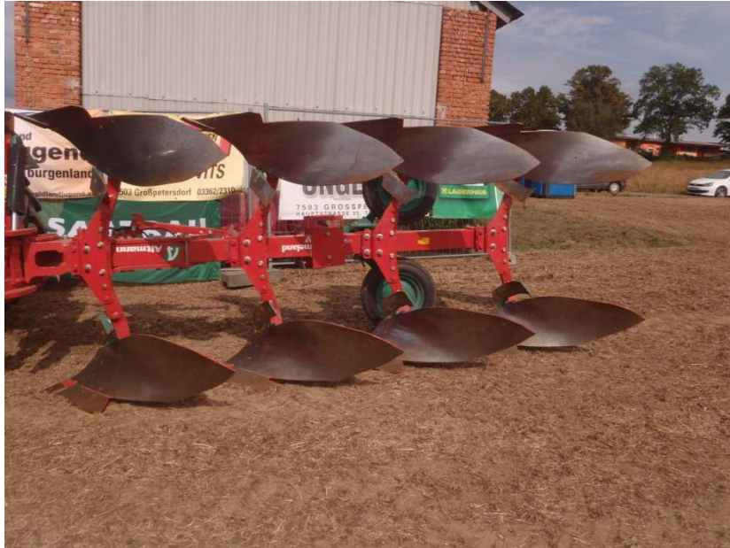
Abb.2: Einstellmöglichkeiten eines Vario Pfluges ausnutzen – z.B. schmale Saatfurche, verringerte Pflugtiefe
