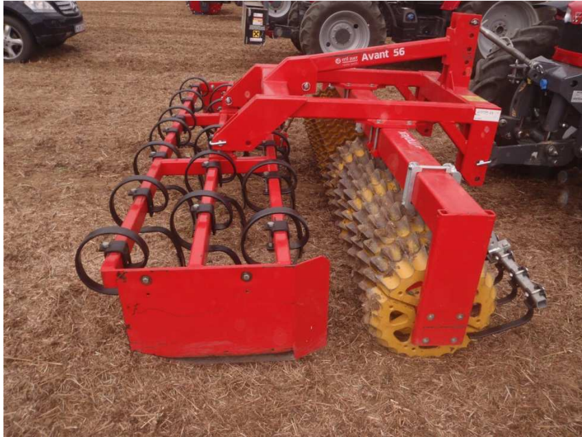
Abb.9: Aktives Frontgewicht: bei Straßenfahrt als Gegengewicht, im Acker als Vorwerkzeug
