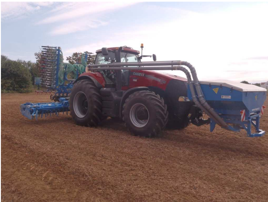
Abb.7: Hohe Eigengewichte von Kreiseleggen-Sämaschinen-Kombinationen belasten die Hinterachse – Saattank im Frontanbau verbessert die Gewichtsverteilung
