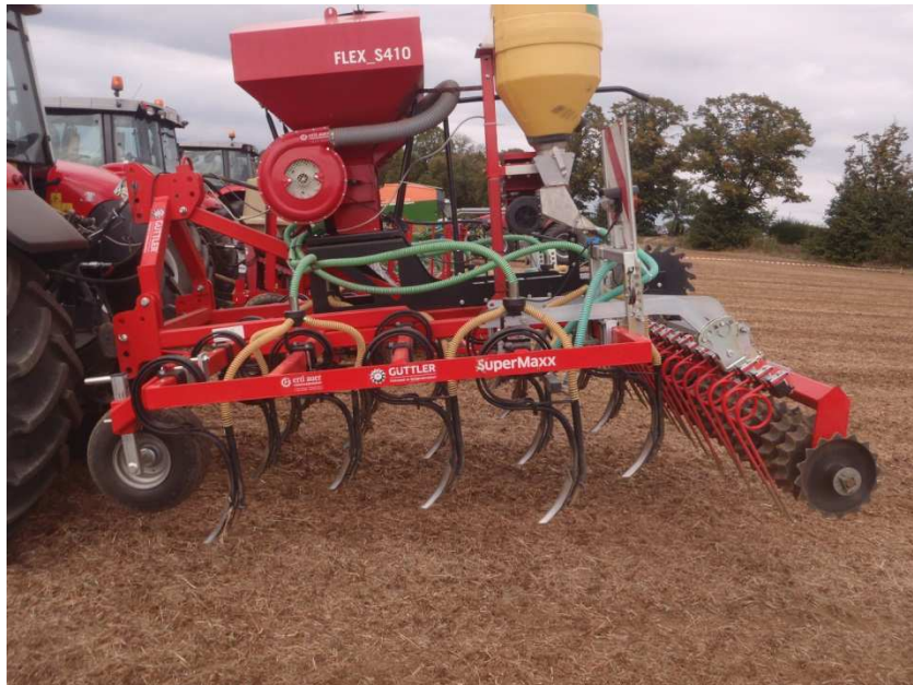
Abb.8: Feingrubber – Zinkensägerät mit Tiefenführung auf vorderen Stützrädern
