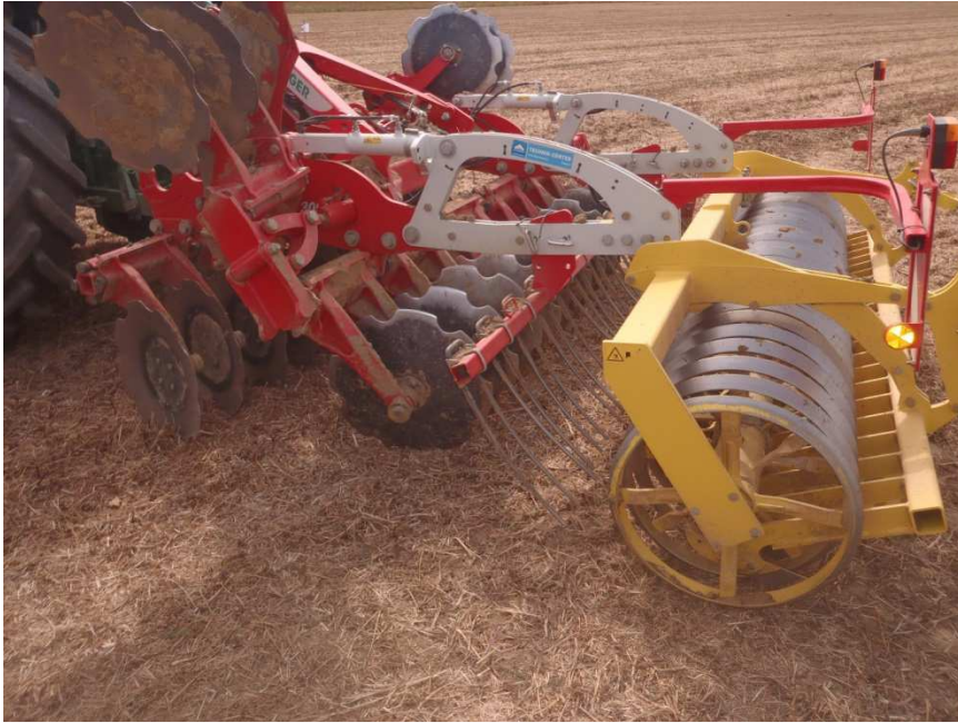
Abb.6: Kurzscheibenegge schafft seichte Bodenbearbeitung - leider nicht ohne Rückverdichtung einsetzbar
