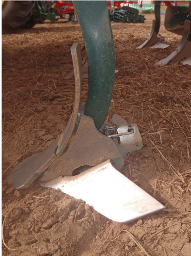
Abb.5: Beispiel eines Schnellwechselsystems zur schnellen Demontage der Flügel
