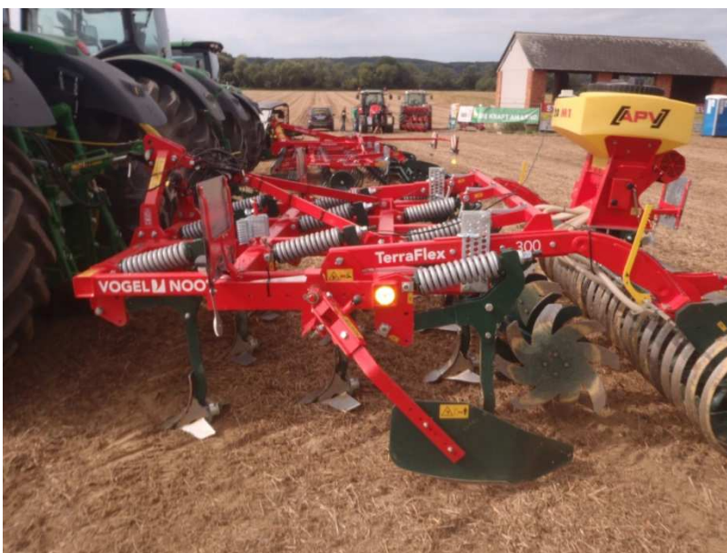
Abb.4: Grubber mit Flügelscharen, die werkzeuglos abgenommen und am Rahmen transportiert werden können
