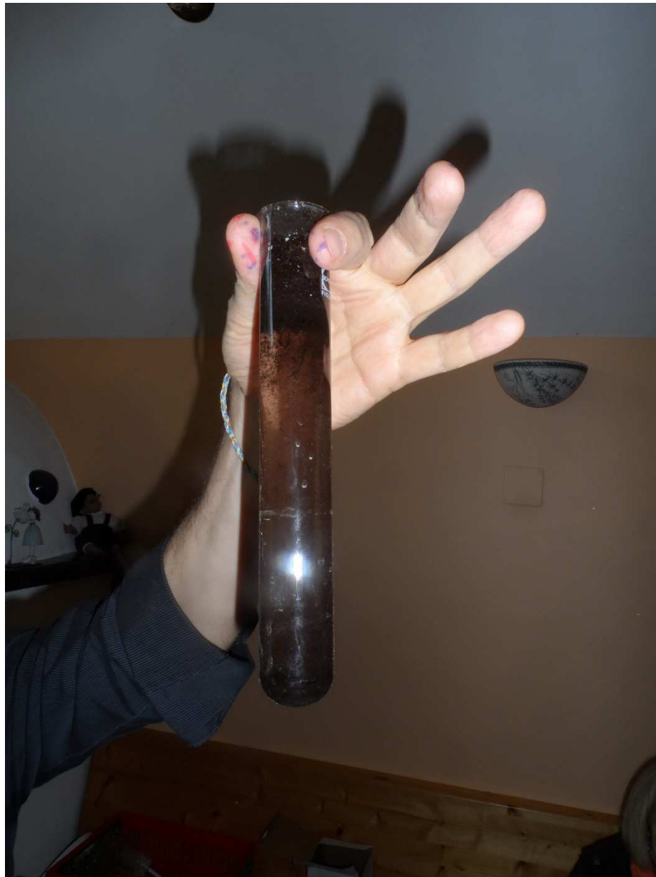
Abb.4: Färbung: gelöste Stoffe färben das Wasser, Sie können durch die Probe durchsehen
