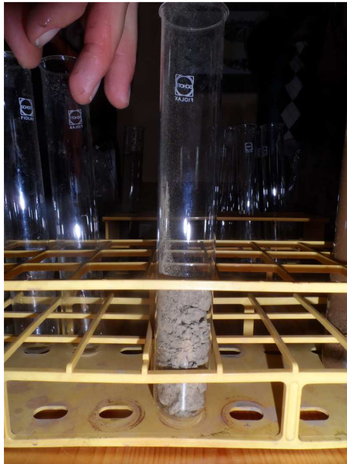
Abb.1: Ein Drittel des Glases mit durchmischtem Probematerial anfüllen (danach zwei Drittel destilliertes Wasser nachgießen)
