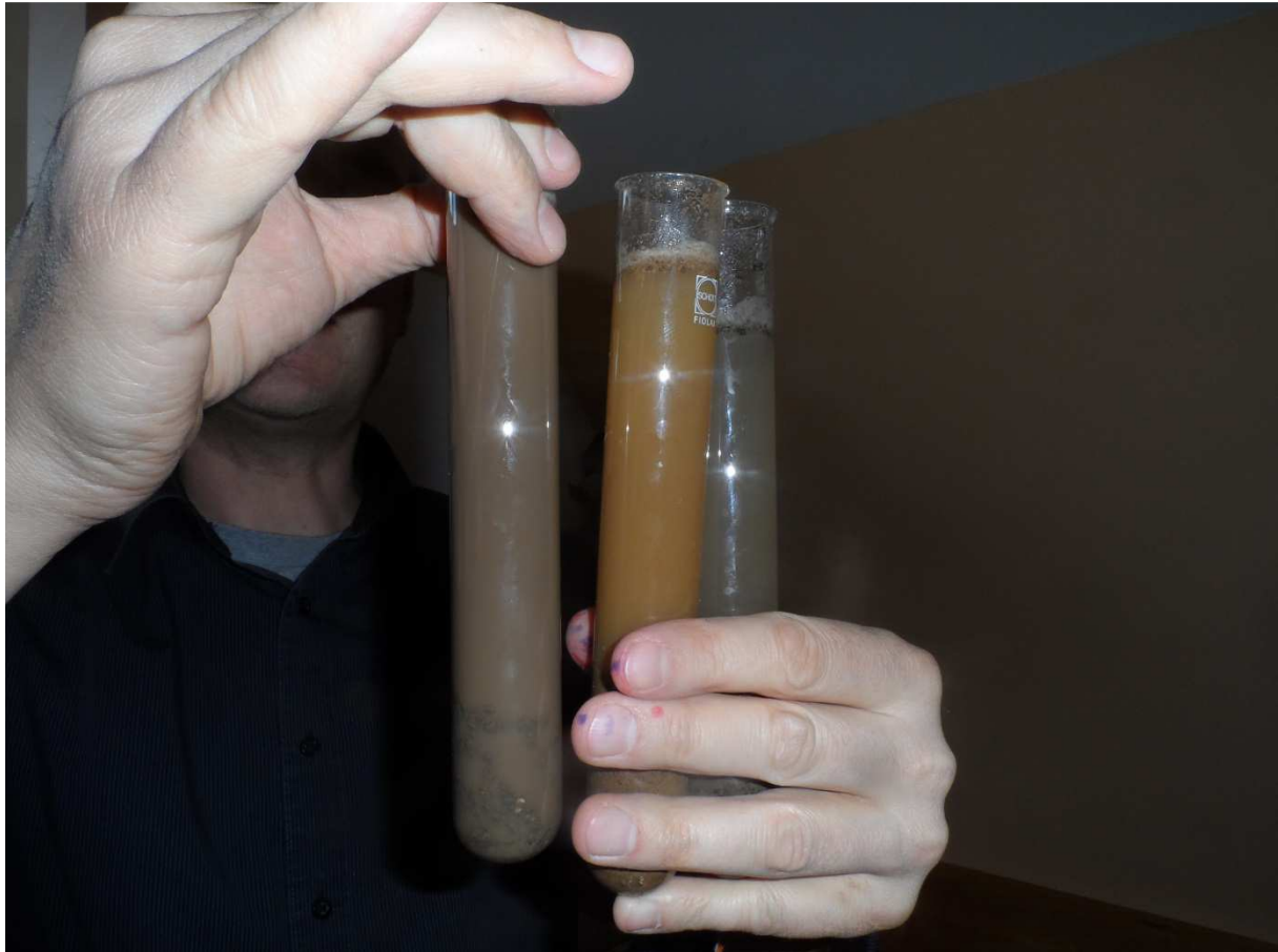
Abb.3: Trübung: die Bodenteilchen sind in Schwebelösung (nicht gelöst), Sie können durch die Probe nicht durchgesehen
