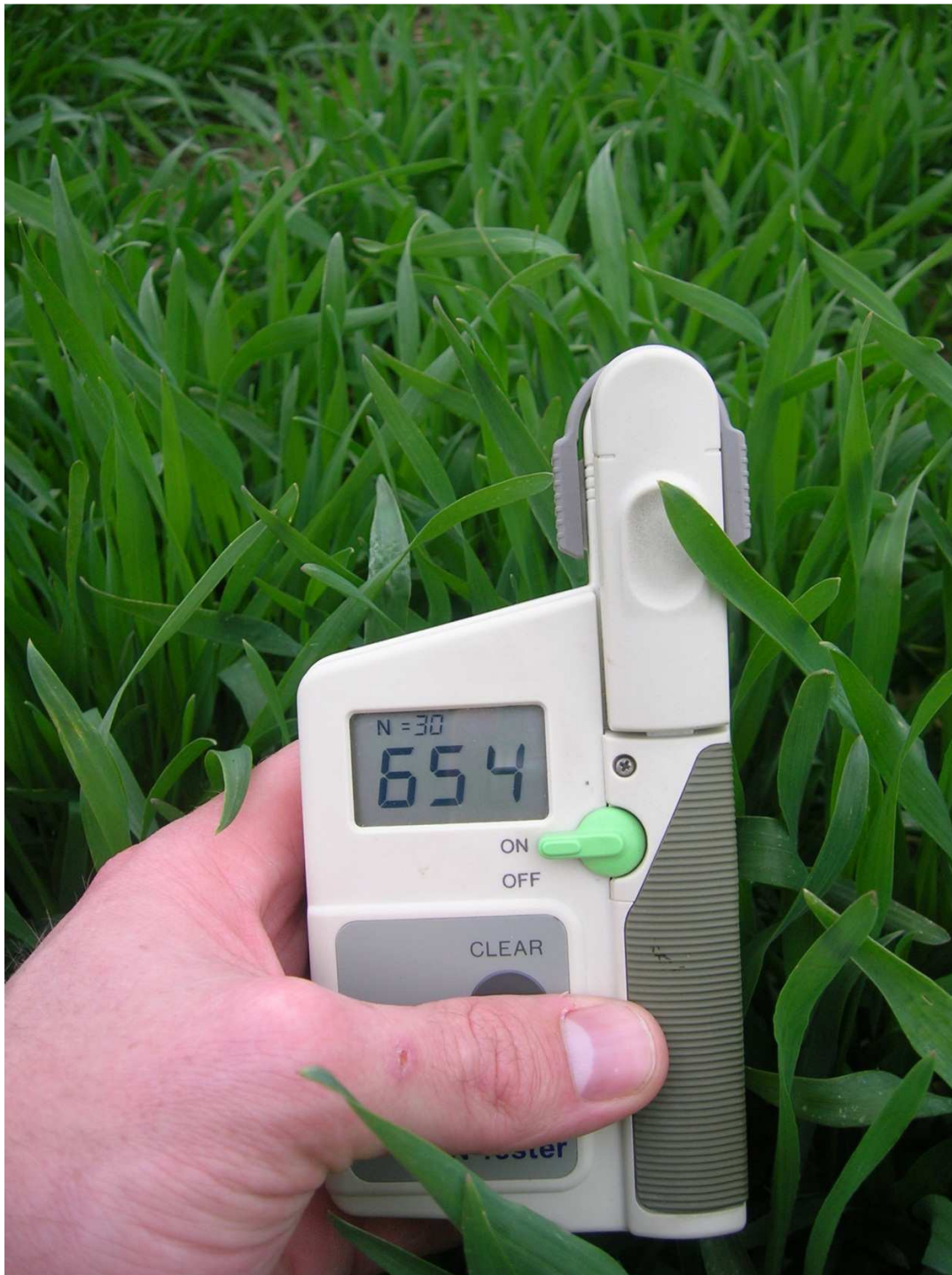
Abb. 1 Der N-Tester misst die Blattfarbe der Getreidepflanzen
