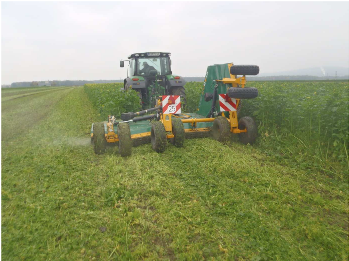
Abb.3: Sichermäher mit großer möglicher Arbeitsbreite, Schwadbildung
