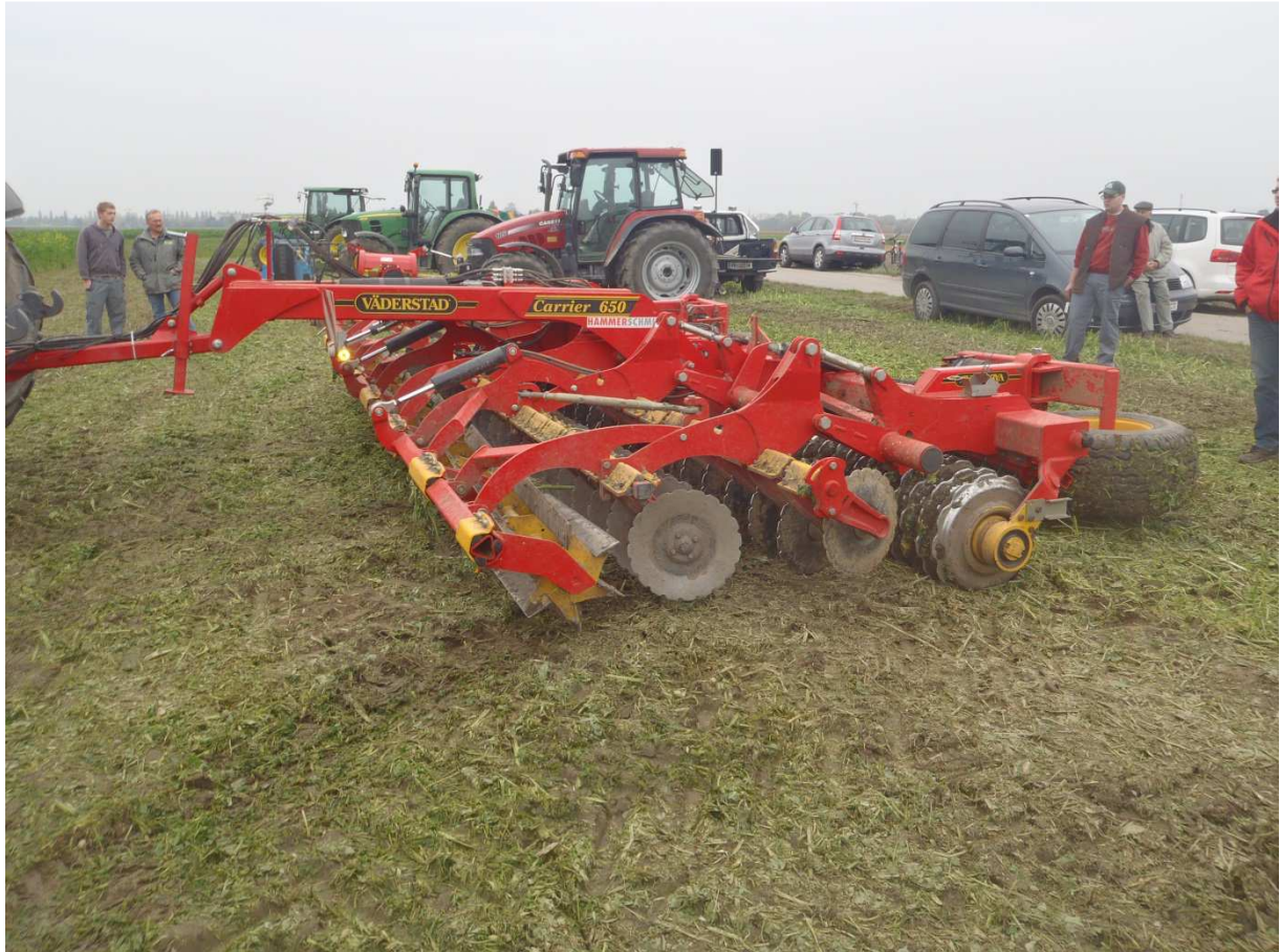
Abb.9: Messerwalze zerkleinert die Biomasse vor der Einarbeitung durch die Kurzscheibenegge
