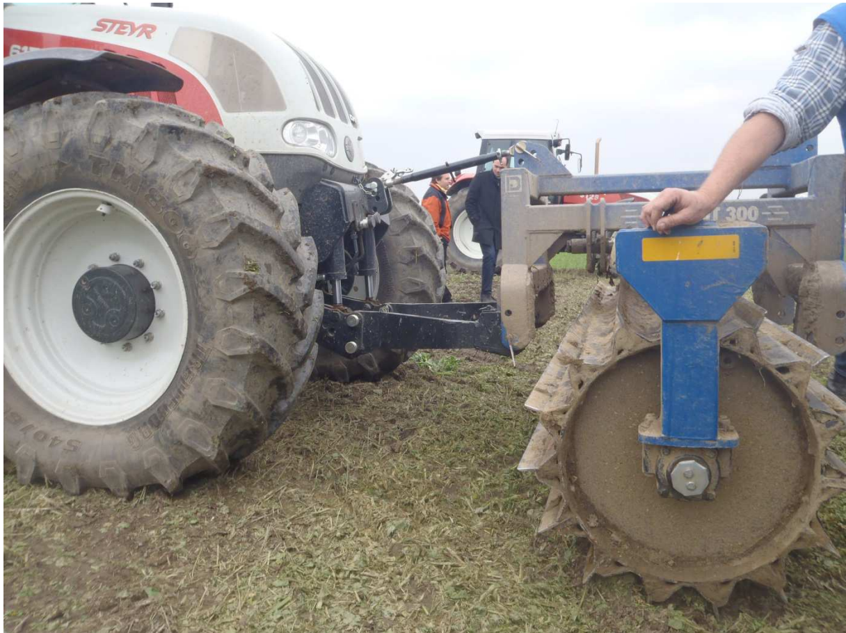
Abb.4: Messerwalze mit Beschwerungsmöglichkeit durch Wasserfüllung
