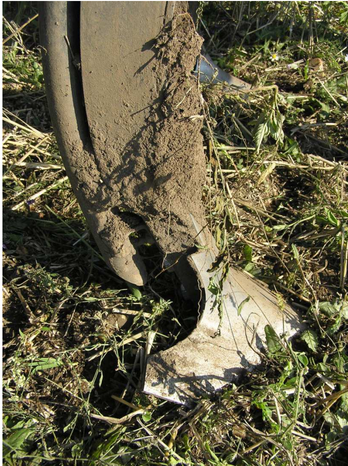
Abb.3: Gänsefußschar ohne wesentlichem Untergriff der Spitze: gleichmäßig seichte Bodenbearbeitung
