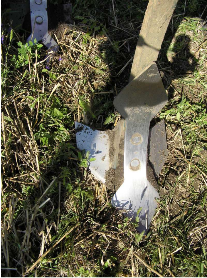
Abb.4: Doppelherzschar mit Flügeln: durch deutlichen Untergriff der Spitze keine gleichmäßig seichte Bodenbearbeitung möglich
