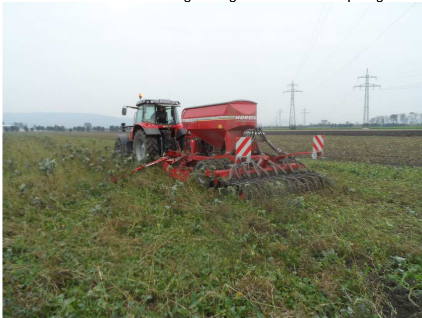
Abb.3: Verstopfungsfreie Saat mit Mulchsaatmaschine in die stehende Begrünung
