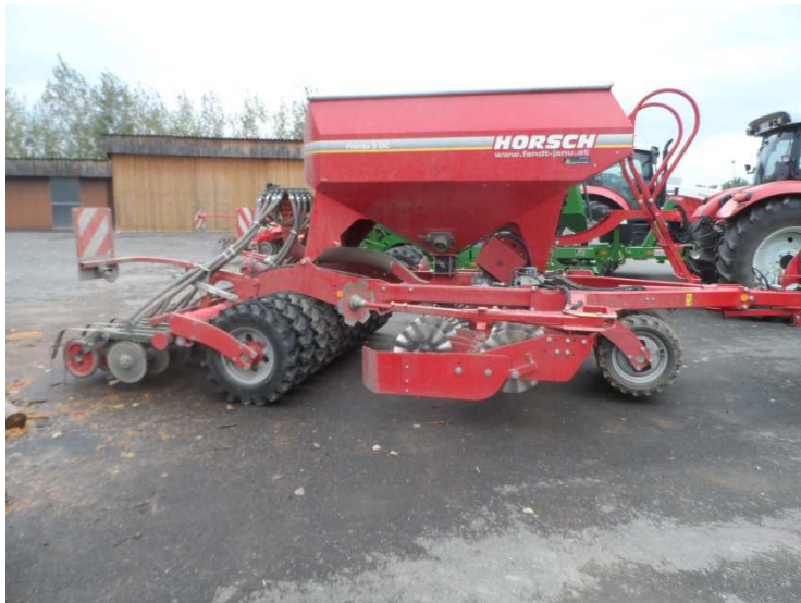
Abb.2: Mulchsaatmaschine mit Coulterscheiben und Doppelscheiben-Säschar
