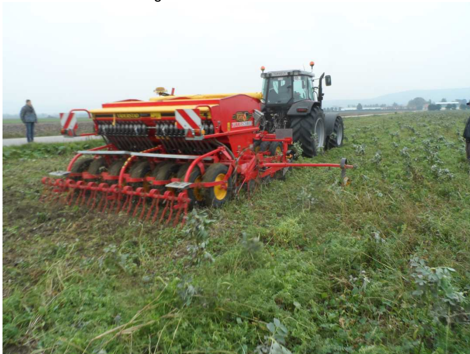
Abb.6: Verstopfungsfreie Saat mit Mulch-/Direktsaatmaschine in die stehende Begrünung
