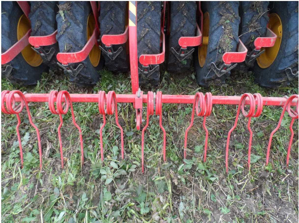
Abb.8: Mulch-/Direktsaatmaschine: Mulchsaat mit Vorwerkzeugen: Weizen fast zur Gänze eingebettet
