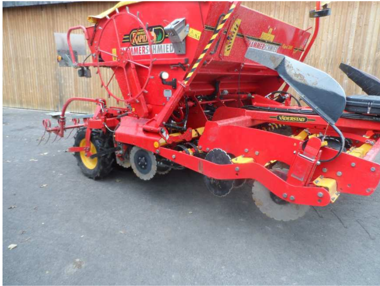
Abb.5: Mulch-/Direktsaatmaschine mit Kurzscheibenegge als Vorwerkzeug und Einscheiben-Säschar
