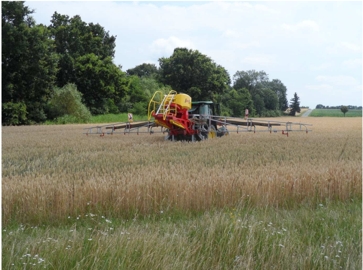
Abb.2: Pneumatisches Sägerät mit klappbarem Gestänge bei der Aussaat in den stehenden Bestand
