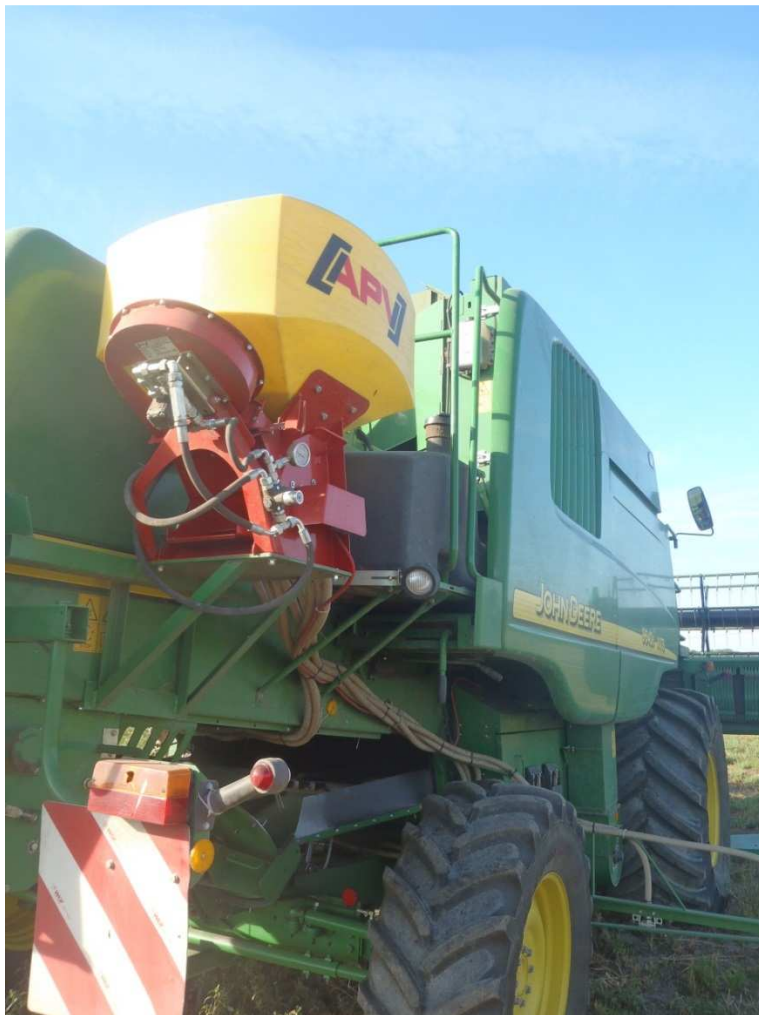
Abb.1: Pneumatisches Sägerät an der Strohhaube, klappbares Gestänge mit Pralltellern im Zwischenachsbereich
