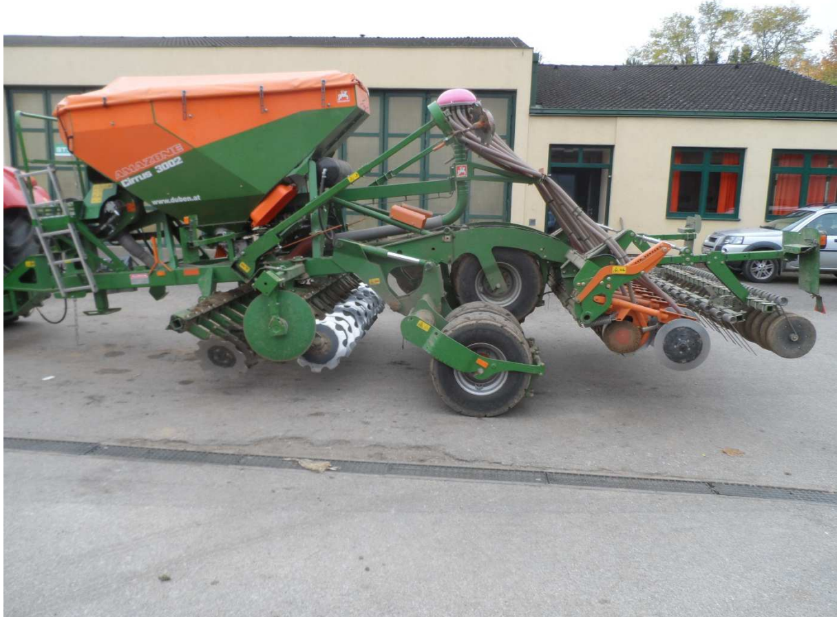
Abb.1: Mulchsaatmaschine mit Vorwerkzeug Kurzscheibenegge, Reifenpacker, Scheibenschar, Striegel und Andruckrolle
