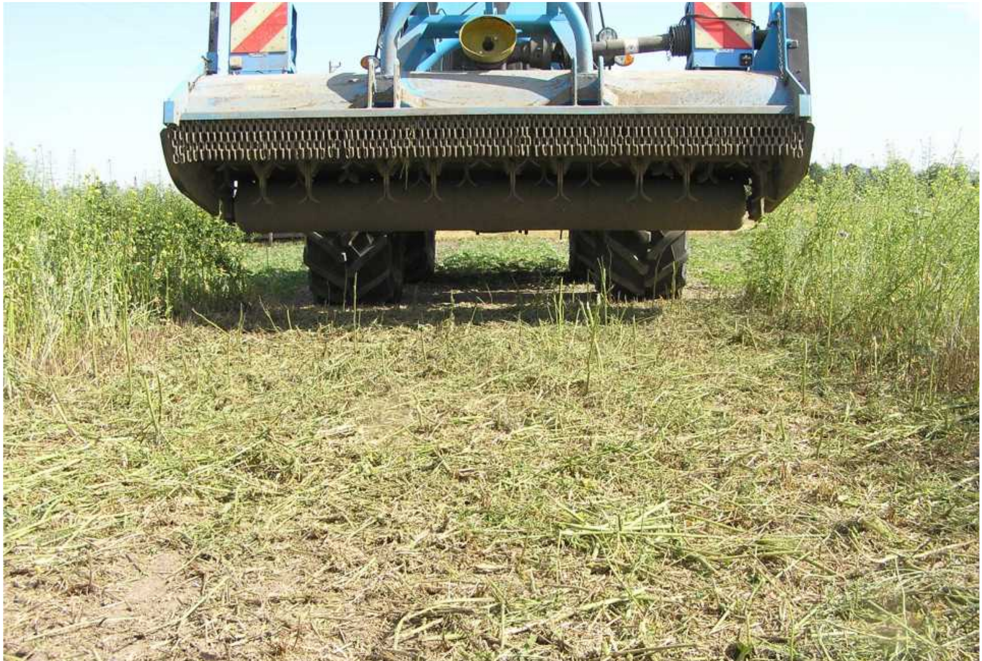
Aufnahme vom 23.8.2012; Fronthäcksler mit Y-Messern, Zwischenfruchtmischung bodennah abgeschlagen und zerkleinert
