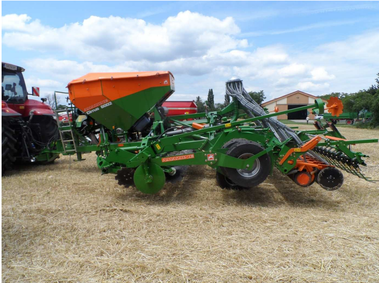
Abb.6: Amazone Cirrus 6002 mit Kurzscheibenegge, Reifenpacker, Scheibenscharen und Saatstriegel
