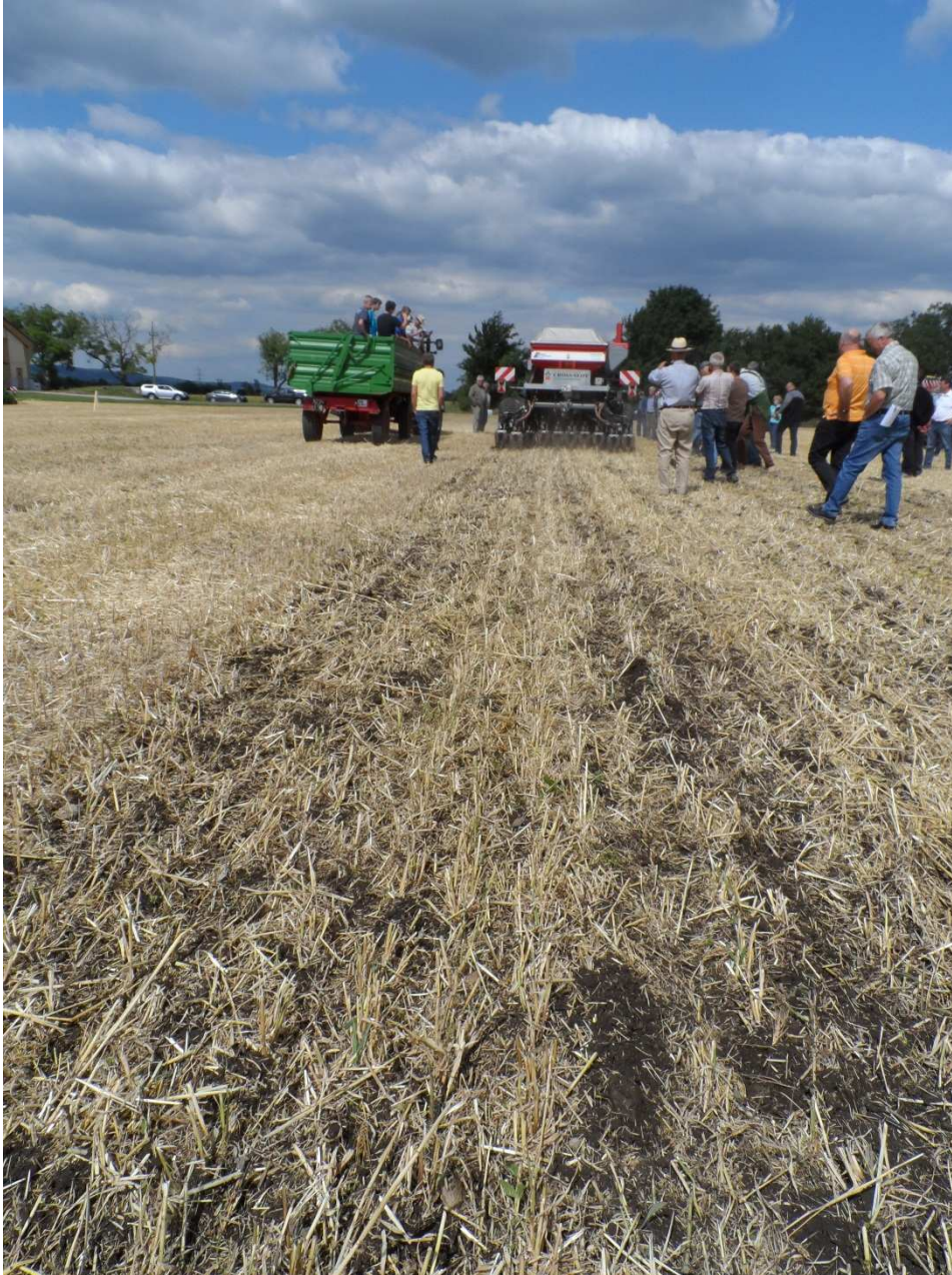
Abb.19: Arbeitsbild der Cross Slot in Getreidestoppel mit schlecht verteiltem Stroh bei lockerem Boden
