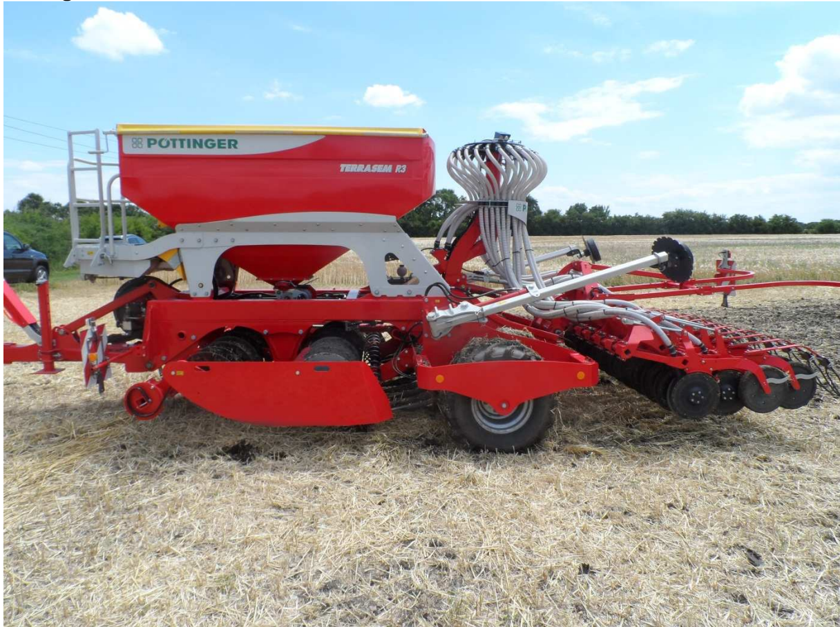
Abb.8: Pöttinger Terrasem R3 mit Kurzscheibenege, Crossboard, Reifenpacker, Scheibenschare, Andruckrolle und Striegelzinken
