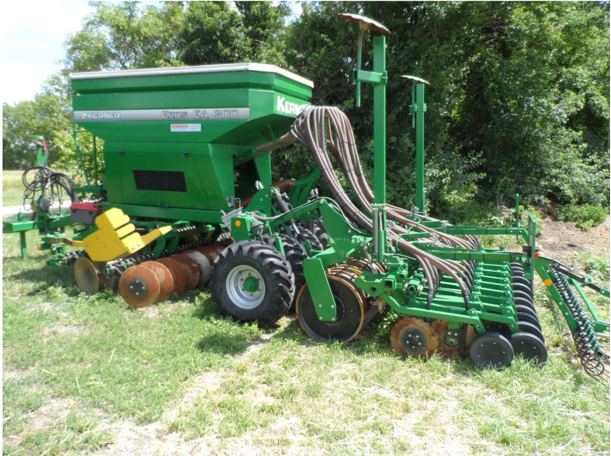
Abb.10: Kerner Eros RA 300 mit Kurzscheibenegge, Reifenpacker, Stahlpacker, Einscheibenscharen, Andruckrollen und Saatstiegel
