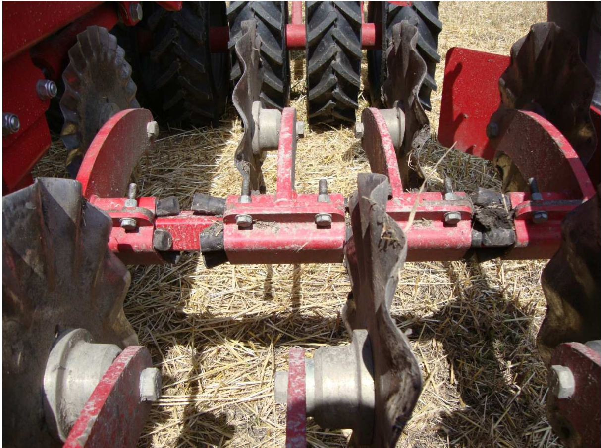
Abb.15: Coulterscheiben sollen Feinerde erzeugen um nach der Saat den Säschlitz schließen zu können
