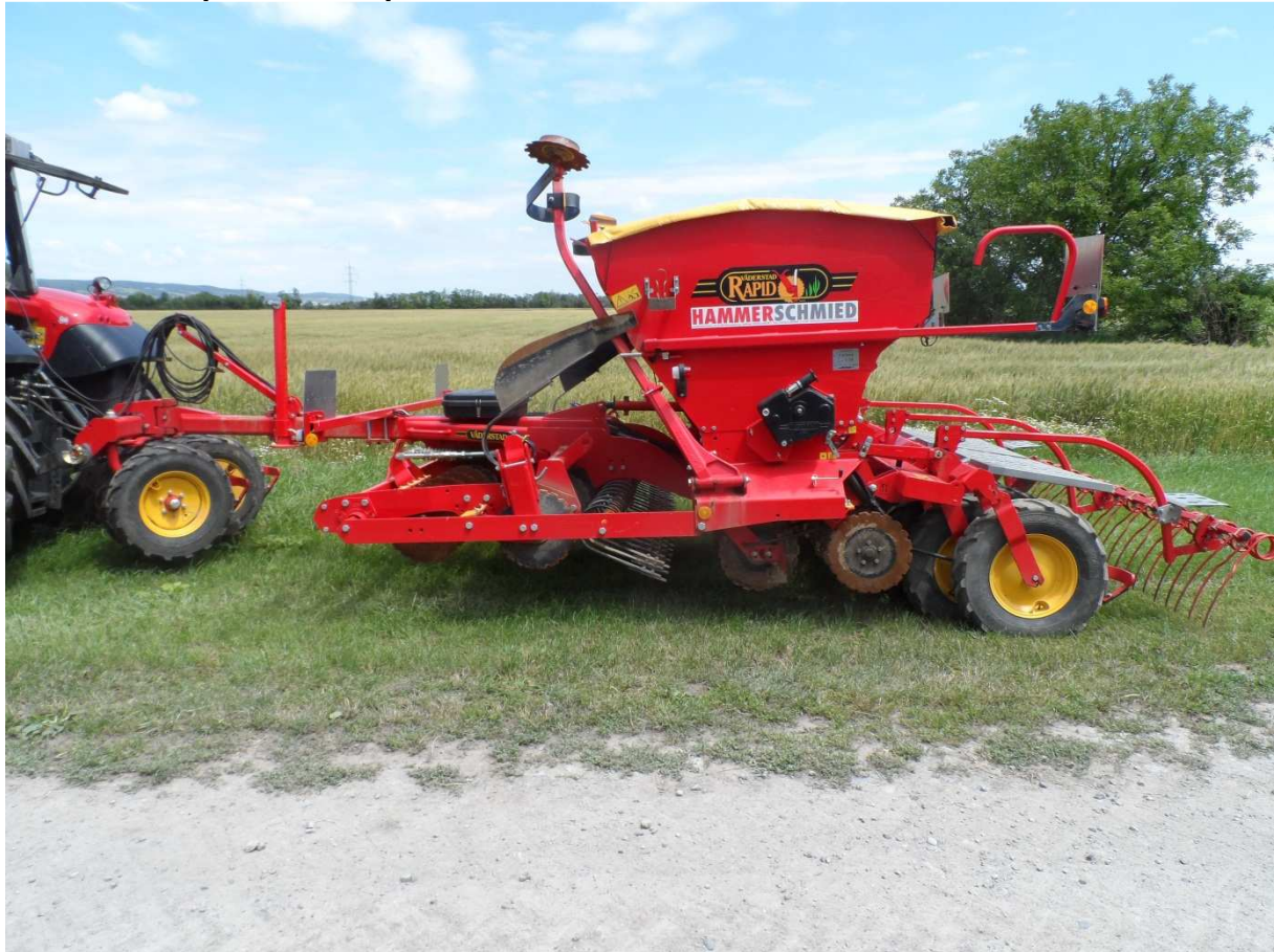
Abb.12: Väderstad Rapid 300 S Super XL mit Kurzscheibenegge, Crossboard, Scheibenscharen, Rifepacker und Striegel
