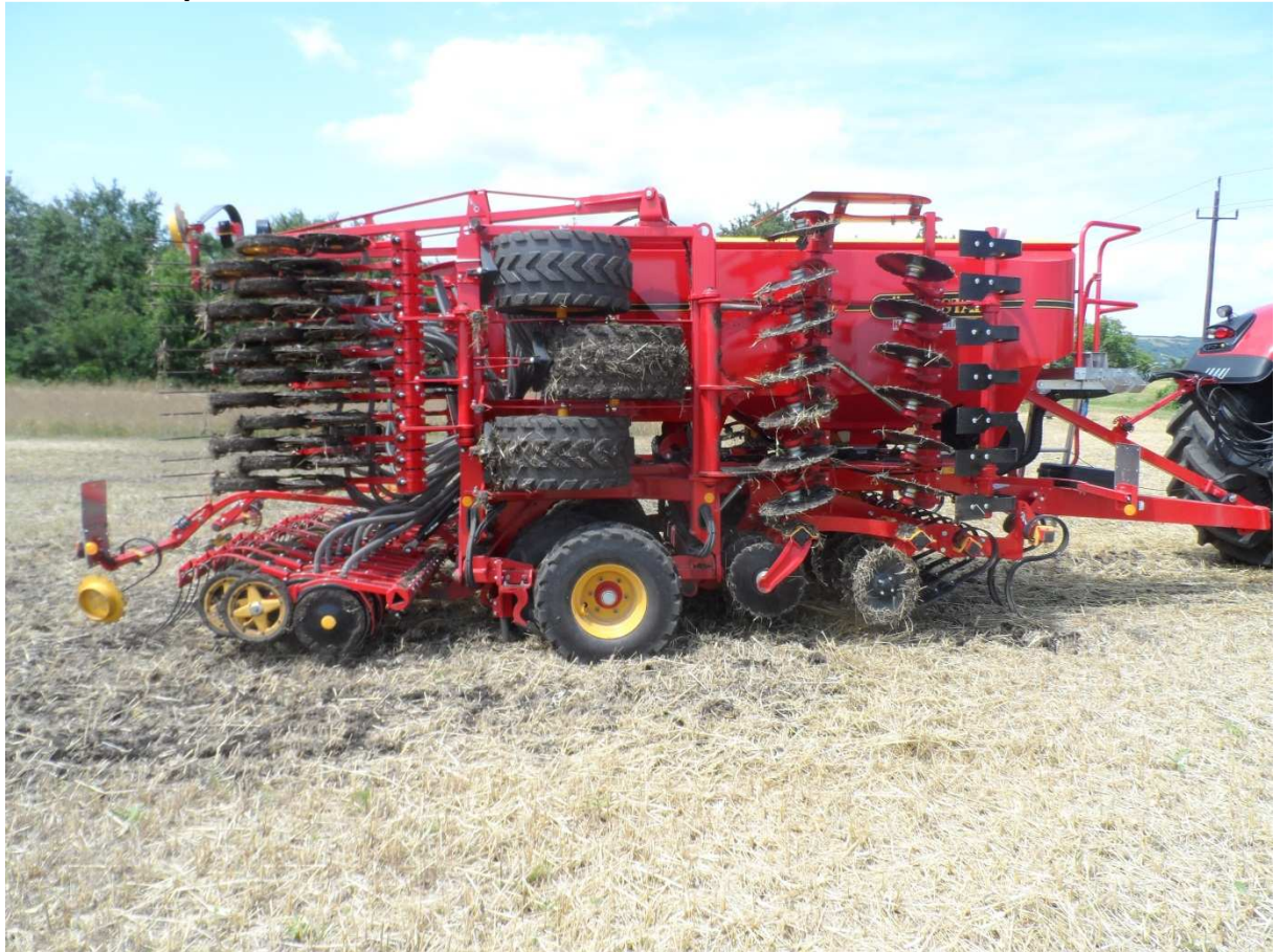
Abb.4: Väderstad Spirit 600 S XL mit Crossboard, Kurzscheibenegge, Reifenpacker, Scheibenscharen, Andruckrolle und Striegel
