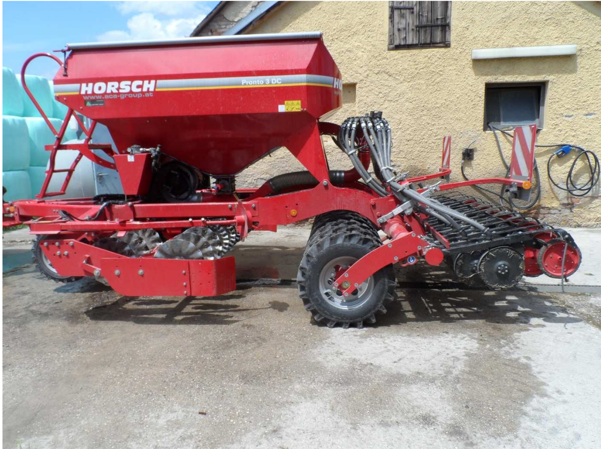
Abb.14: Horsch Pronto 3 DC mit Coulter-Scheiben als Vorwerkzeug, Reifenpacker, Säscheiben, Andruckrolle und Striegel
