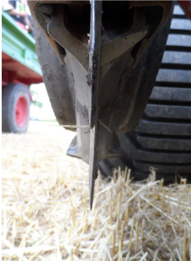
Abb.18: Cross Slot Säscheibe mit Flügelelementen für die Saatgut- und Düngerablage
