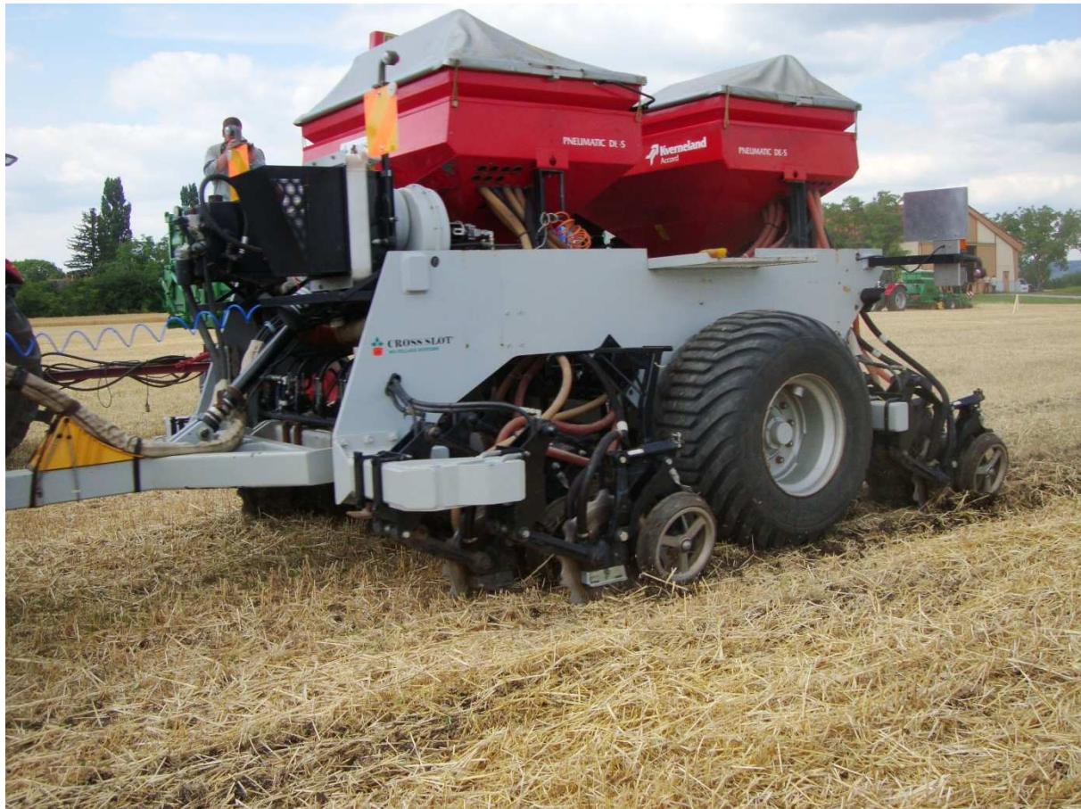
Abb.17: Cross Slot mit hohem Eigengewicht– Säscheiben und Andruckrollen
