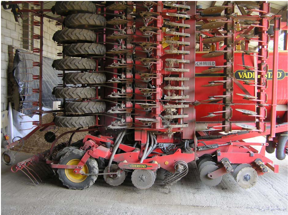
Abb.3: Einsaat der Begrünungsmischung – Kurzscheibenegge, Crossboard, Scheibenschare, Packerräder, Striegel
