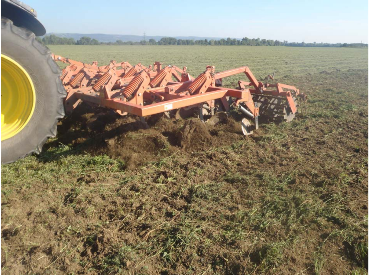
Abb.9: Luzerneumbruch am Seehof, Flügelschargrubber, Einebnungscheiben, Rohrstabwalze, Striegel
