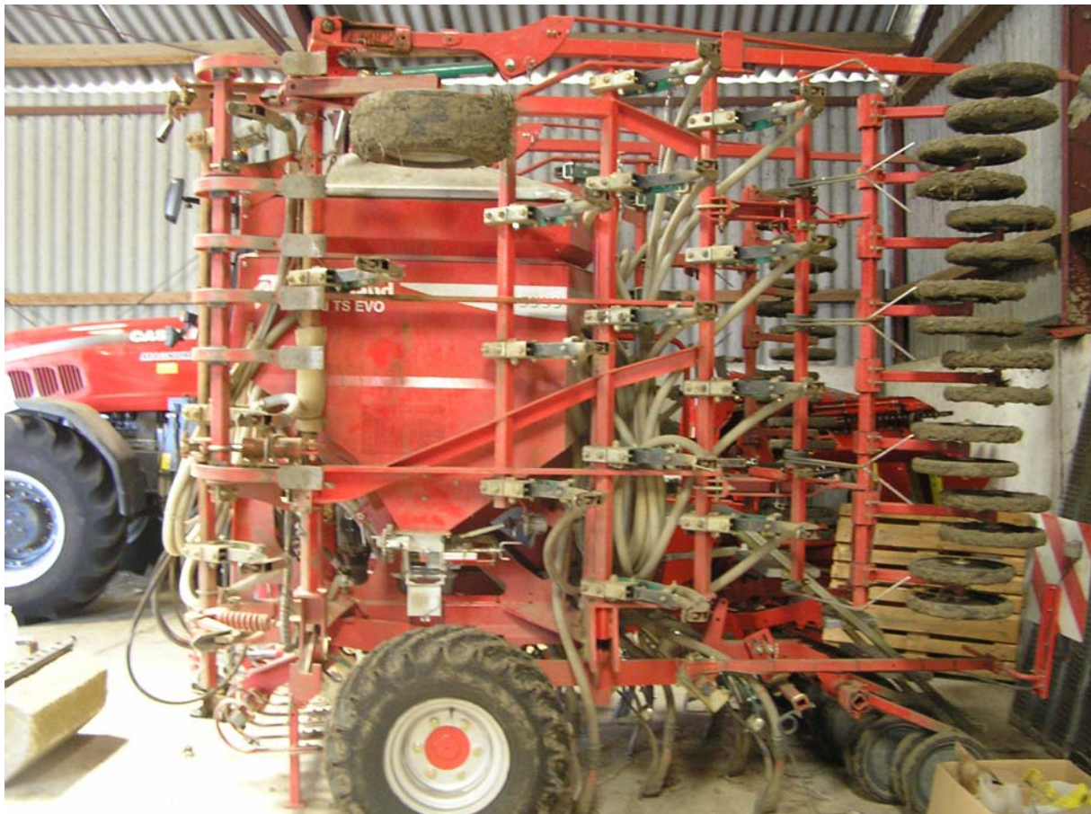
Abb: Zinkensäsystem mit Crossboard, mittig angeordnete Führungsräder, Zinken, Striegel und Andruckrollen
