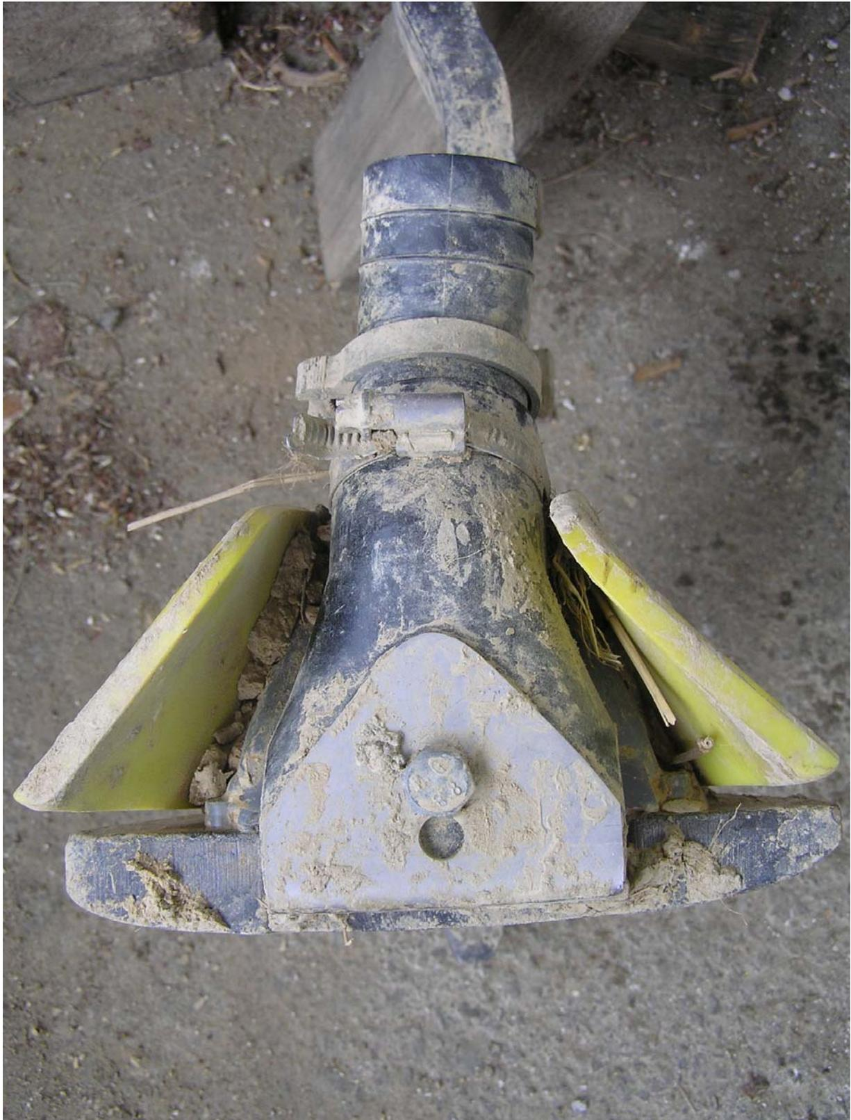
*Abb.2: Bandsaatsystem von hinten, beidseitige Saatgutauslässe*
