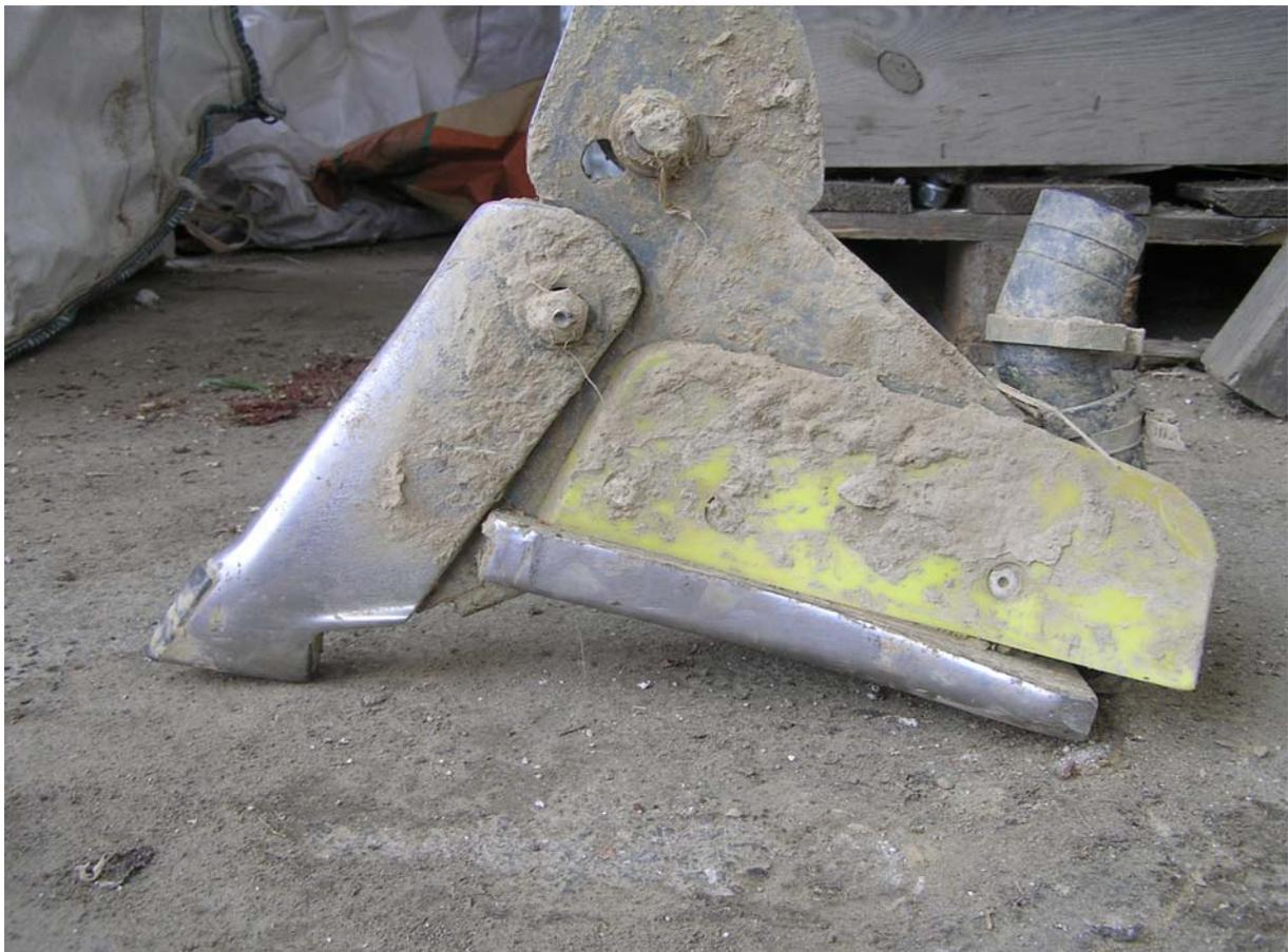
*Abb. 1: Bandsaatsystem von der Seite, gehärtete Scharspitze mit Untergriff, Gleitplatte*
