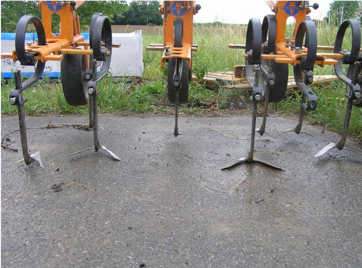
Abb.6: Hacksystem: äußerste Reihe: 3 Schare, zwischen der Doppelreihe: 1 Schar, weite Reihe: 4 Schare
