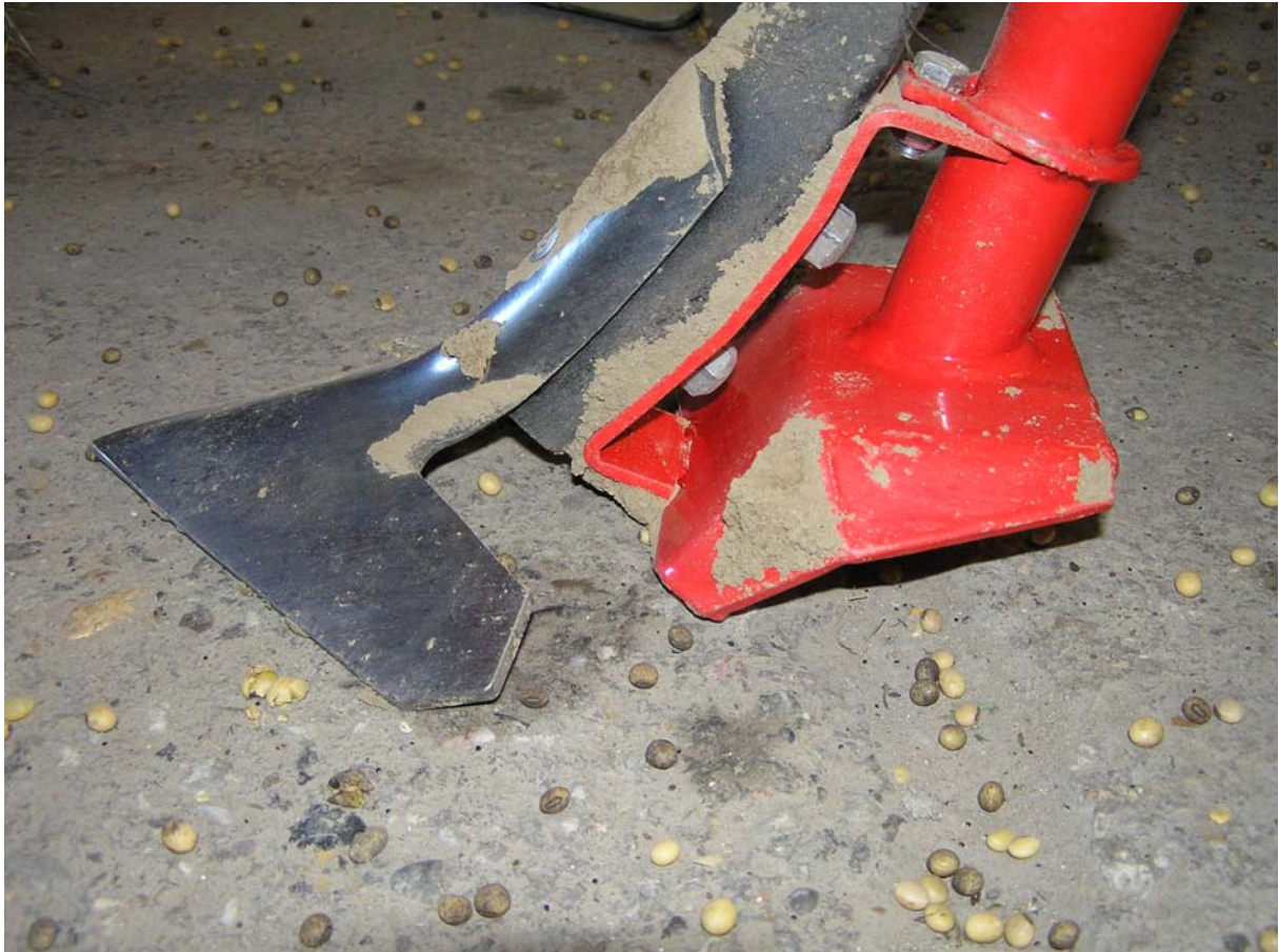
Abb. 5: breites Saatrohr für die Bandsaat von z.B. Soja – von oben
