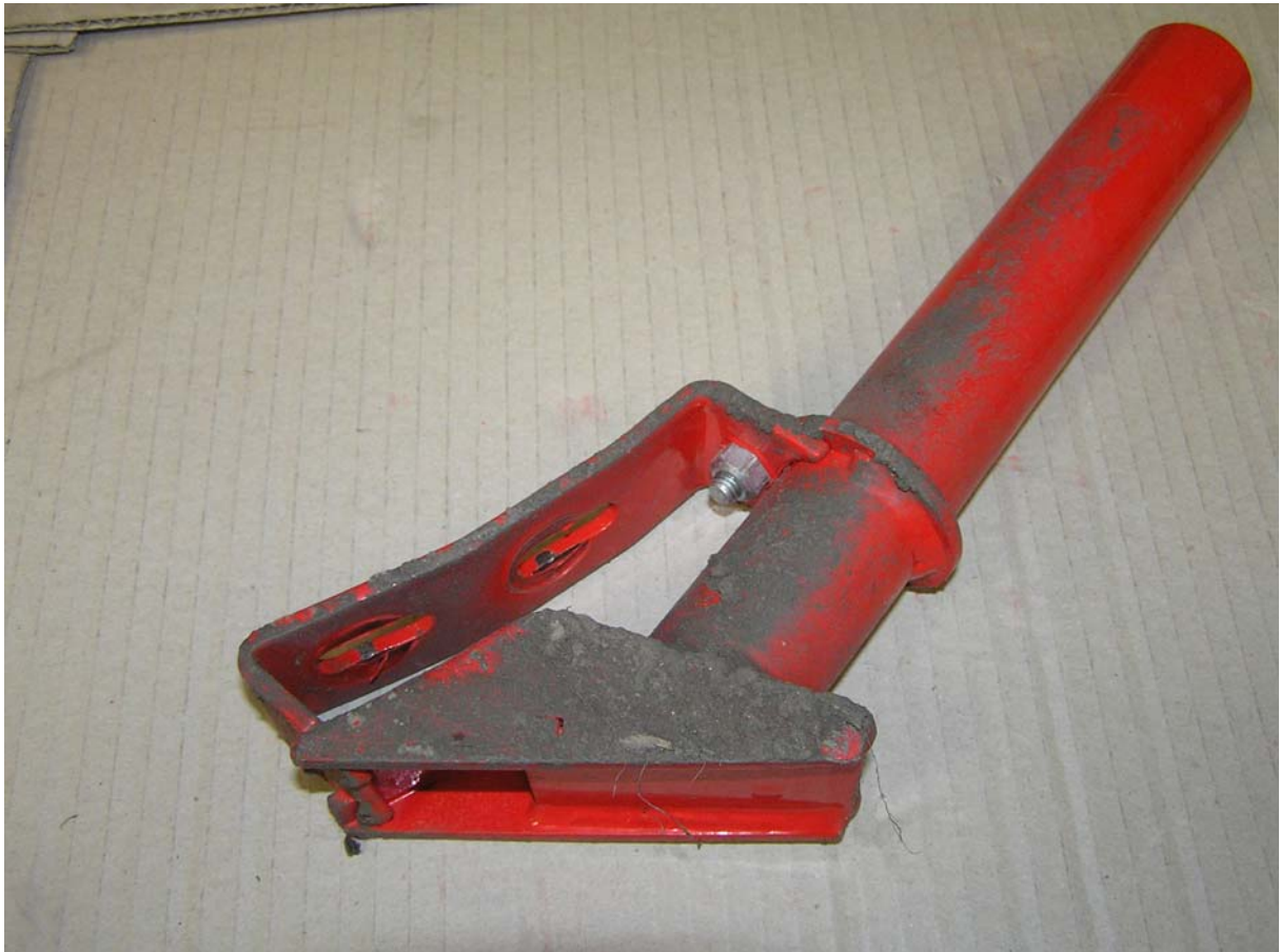
Abb. 4: enges Saatrohr für die exakte Tiefenablage von z.B. Erbsen oder Ackerbohnen oder die Mulchsaat von Weizen nach Mais
