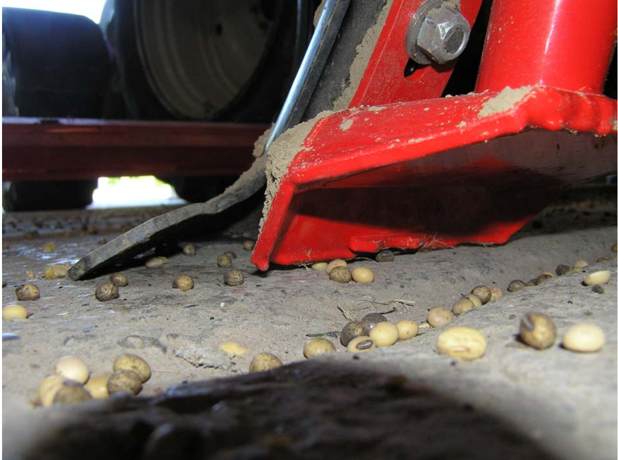
Abb. 6: breites Saatrohr für die Bandsaat – von unten - Prallteller und geschützte Ablage unter den Erdstrom.
