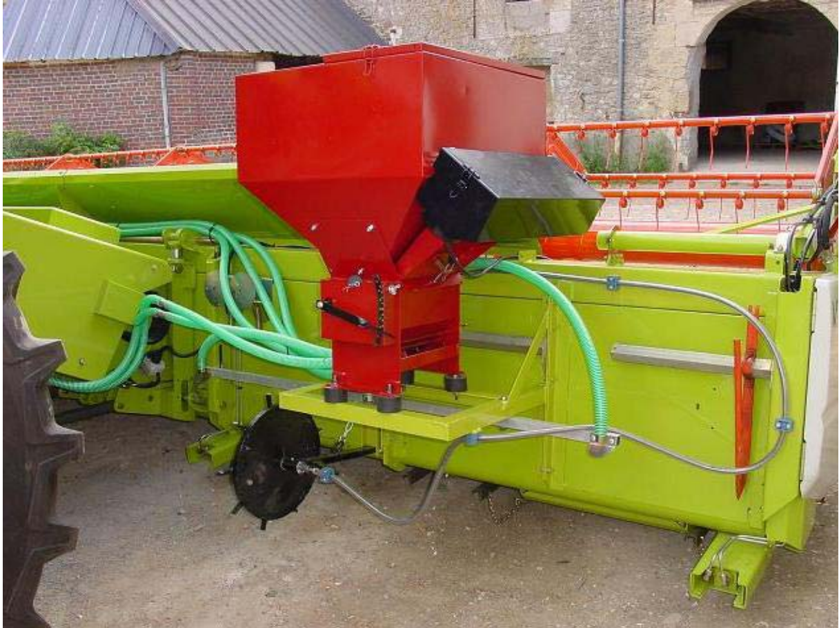
Abb. 3: Aussaat hinter dem Schneidtable – ältere Bauart – auch für große Schnittbreiten geeignet Quelle: www.direktsaat.eu
