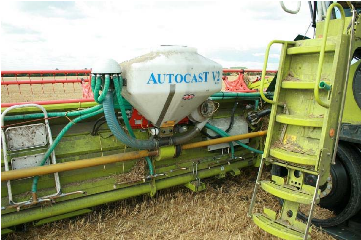
Abb.2: Aussaat hinter dem Schneidtable – neuere Bauart – auch für große Schnittbreiten möglich
