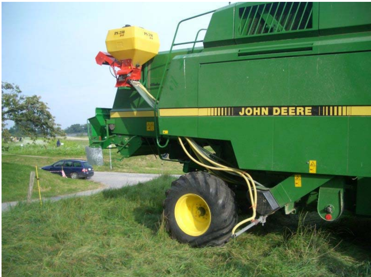
Abb. 1: Aussaat im Zwischenachsbereich des Mähdreschers – nur für kleine Schnittbreiten möglich
