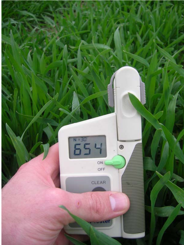
Abb. 1 Der N-Tester misst die Blattfarbe der Getreidepflanzen
